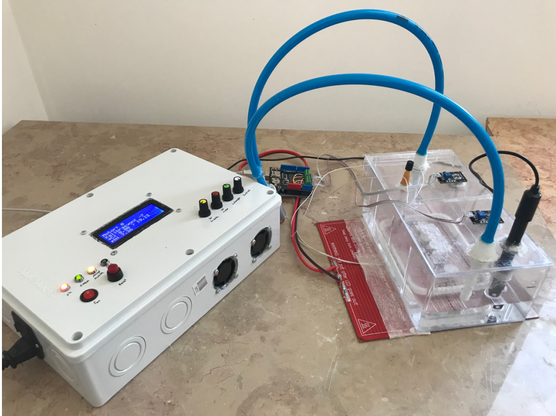
Şekil 5.5. Daldırma deneyi için kullanılan deney düzeneği.
