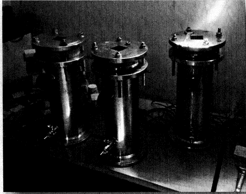
Şekil 4. Permeabilite test hücreleri
