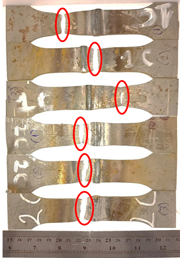
Şekil 5.5. 1C ve 2C çekme numunelerinde çekme deneyi sonucundaki kopma bölgeleri
