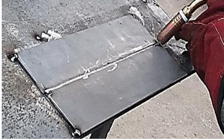
Şekil 4.4. Kaynak masasına puntalanmış, kaynak ağzı açılmış sac plaka malzemenin kaynak işlemi öncesi görüntüsü
