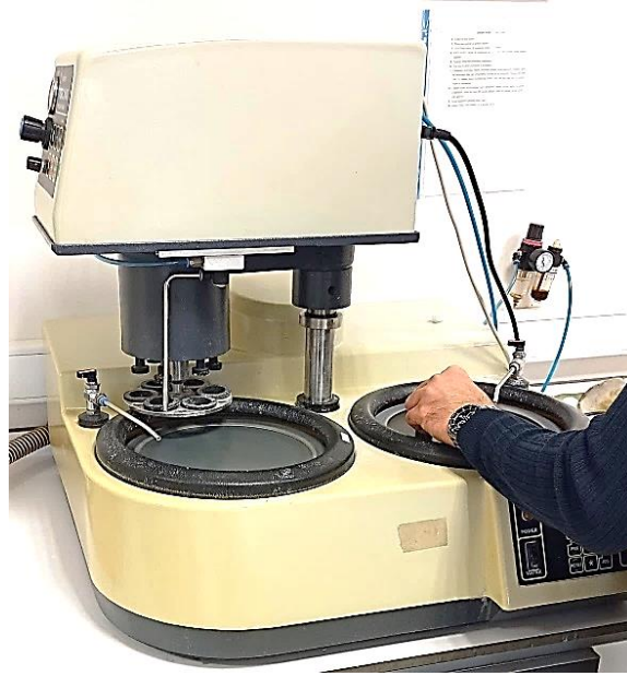
Şekil 4.16. 2B numunesi zımparalama işlemi görüntüsü
