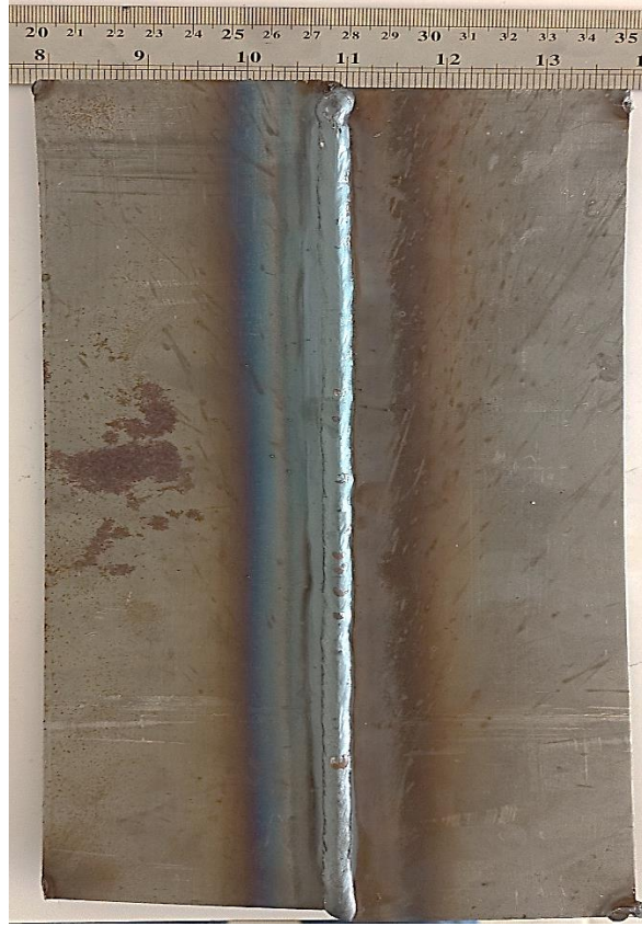
Şekil 4.7. Kaynaklanmış bir plakaya ait cetveli dik görüntü (150 mm)
