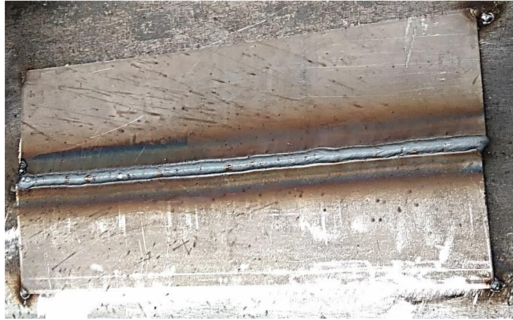
Şekil 4.5. Kaynaklanmış plaka görüntüsü ve kaynak dikişi
