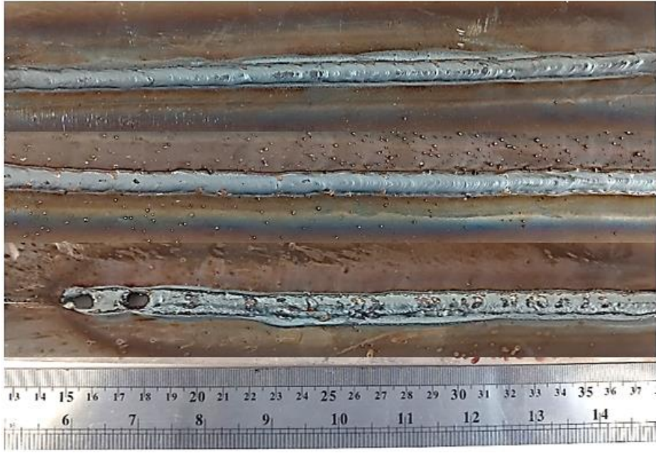
Şekil 5.2. 2A, 2B ve 2C plakalarına ait kaynak dikiş görünümleri (sırasıyla)
