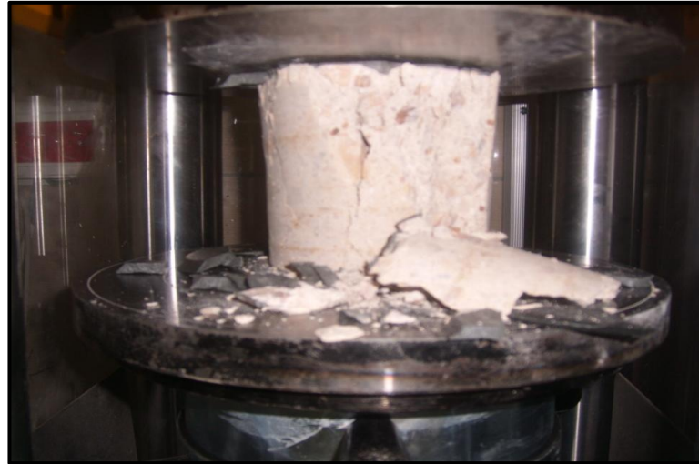
Şekil 5.23 Basınç deneyi sonrası hasar görmüş karot numunesi.
