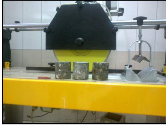
Şekil 4.16 Karot kesme makinesinde numunelerin uygun boyda tıraşlanması.
