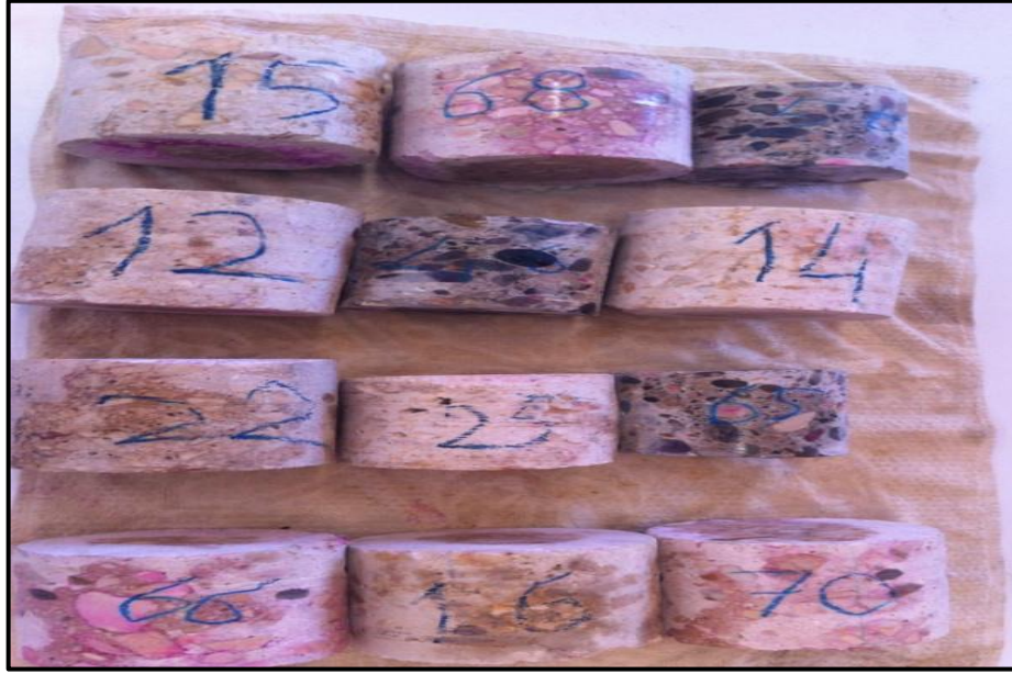
Şekil 4.14 Karot numunelerinde indikatör renk değişimi.
