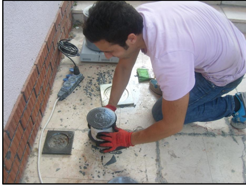
Şekil 4.18 Karot numunesinin kükürt başıklaması.
