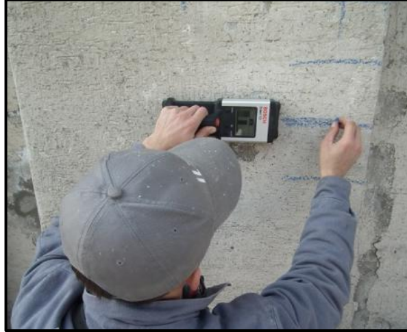
Şekil 4.1 Demir donatı tespit cihazı ile yapıdan numune yerinin belirlenmesi.
