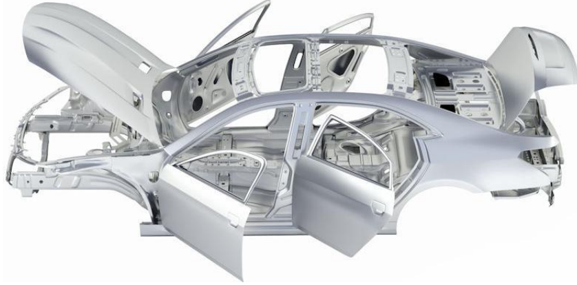
Şekil 1.1. Bir Otomobilde Bulunan Sac Malzemeler
