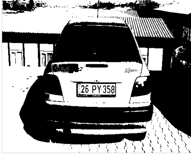
Şekil 3-3 - Görüntünün Otsu Metodu ile İkili Görüntü Haline Getirilmesi
