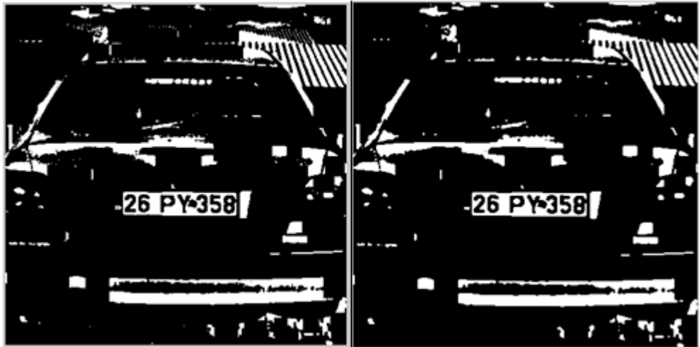
Şekil 2-19 - Median Filtresi Kullanımı Öncesi(Sol) ve Sonrası(Sağ)
