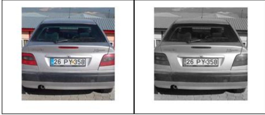
Şekil 2-9 - Renkli Görüntüden Gri Seviyeli Görüntüye Dönüşüm
