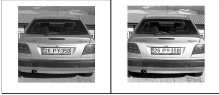
Şekil 2-11 - Görüntünün Histogram Eşitlemeden Önceki ve Sonraki Durumları
