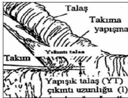
Şekil 3.8. Sıvanmalı sürekli talaş (Aydın, 2002).
