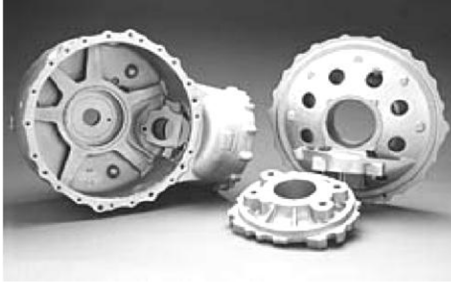
Şekil 2.7. WE43 alaşımından dökülmüş helikopter vites kutusu (Žaludová, 2005).
