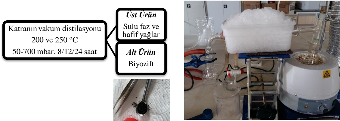
Şekil 7.5. Katrandan biyozift üretim akış diyagramı ve deney düzeneği.
