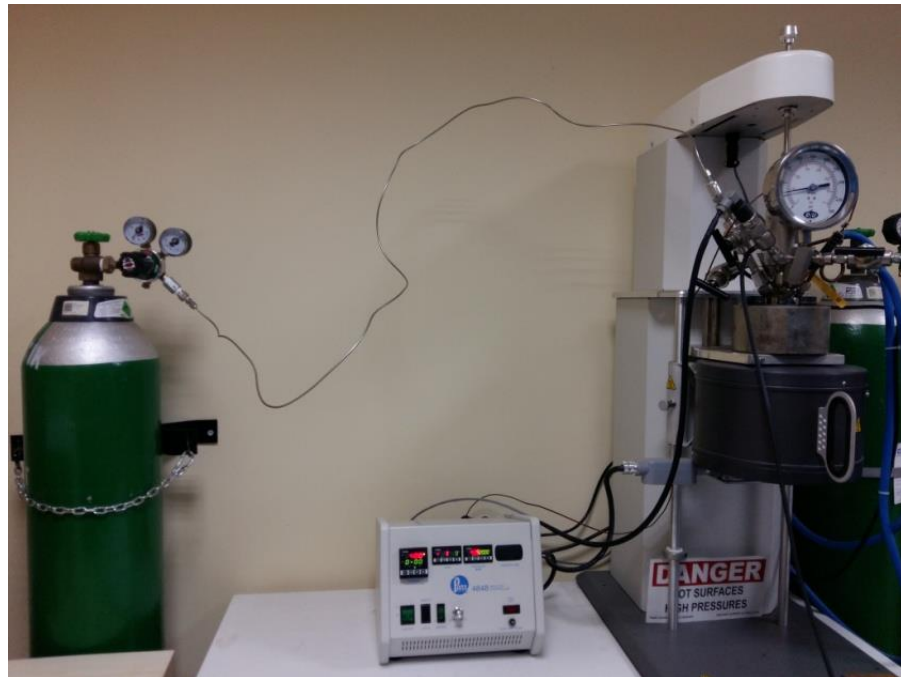
Şekil 7.6. Yüksek sıcaklık/basınç reaktörü.
