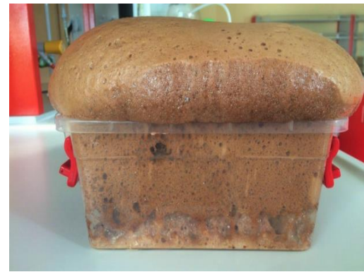
Şekil 7.3. Biyokütle:reaktif =1:3 için reçine köpük ve aktive karbon köpük görüntüleri.
