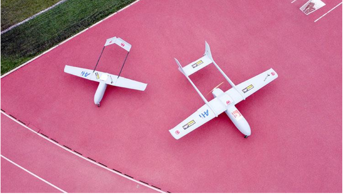
Şekil 1.1. Tek Silindirli 61 cc Motora Sahip İHA
