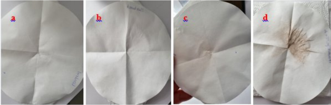
Şekil 4. 27. Serbest ve İmmobilize BCA ile CO 2 'in kalsiyum karbonata dönüşümü sonrası Whatman-42 filtre kâğıdında biriken kalsiyum karbonat (a: Kontrol, b: Serbest BCA, c: MNP-APTES-GA-BCA, d: MNP-TEOS-APTES-GA-BCA)
