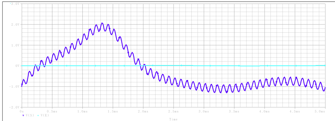
Şekil 4. 140. CCIII ile kurulmuş yayınımsız lorenz sistemi kaotik gizleme yöntemiyle haberleşme devresinin pspice simülasyon sonuçları (verici sistemin X(t) sinyali, alıcı sistemin Xc(t) sinyali, iletilen sinyal S(t) = X(t) + i(t) ve haberleşme hatası e(t) = i(t) - ic(t) , bilgi işareti i(t) ve tekrar elde edilen bilgi sinyali ic(t) 'nin zamana göre değişimi).
