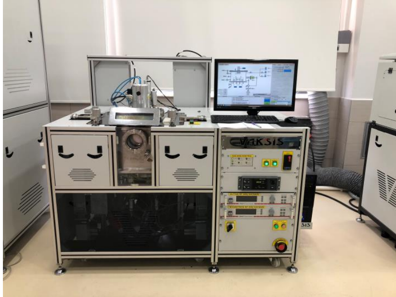
Şekil 3.1. Alaşım filmlerin biriktirilmesinde kullanılan Vaksis Angora magnetron sıçratma cihazının fotoğrafı
