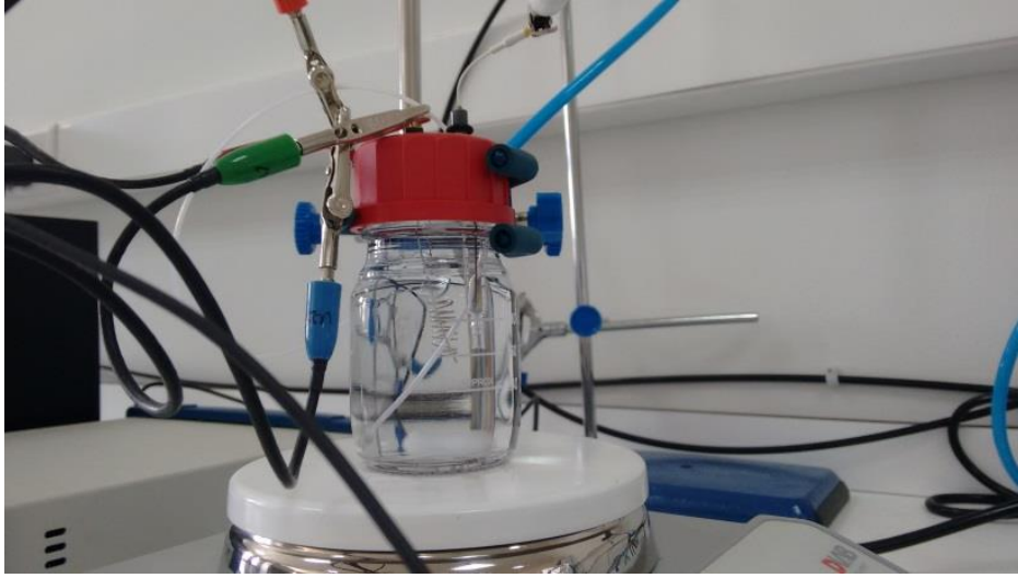
Şekil 3.4. Elektrokimyasal analizlerde kullanılan üç elektrotlu ölçüm hücresinin fotoğrafı
