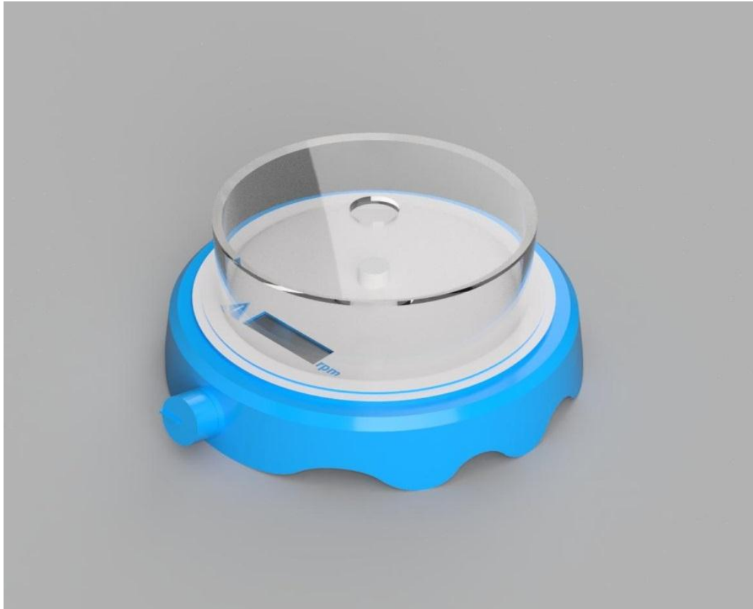
Şekil 3.1. Sol-gel manyetik döndürerek kaplama cihazının gösterimi.
