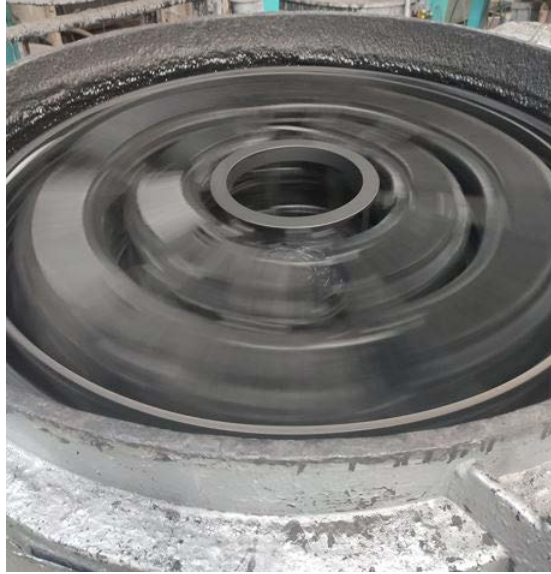
Şekil 4.23. Parçaların kendi etrafında döndürülme işlemi.
