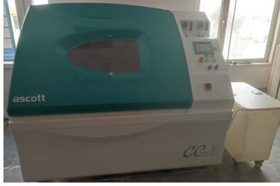
Şekil 6.6. ASCOTT CC1000 IP çevrimsel korozyon test kabini.
