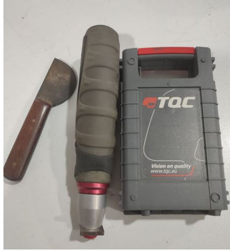
Şekil 6.1. Yapışma testinin ekipmanları.
