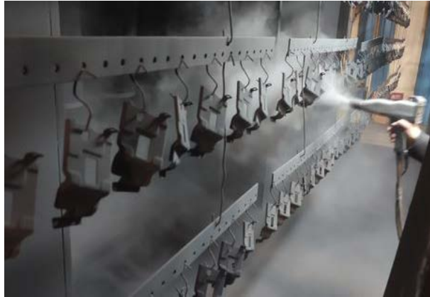
Şekil 4.27. Püskürtme toz boya uygulaması.
