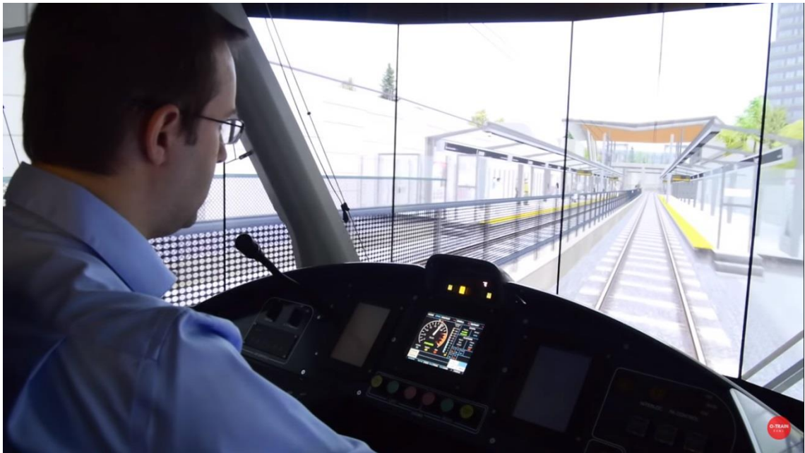
Şekil 4.1. Çoklu ekran benzetim ortamı örneği (URL-6).
