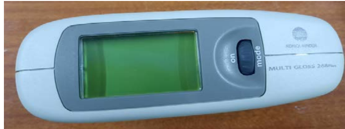
Şekil 3.11. Konica-Minolta Marka Multi Gloss 268 Plus Model Parlaklık Ölçüm Cihazı
