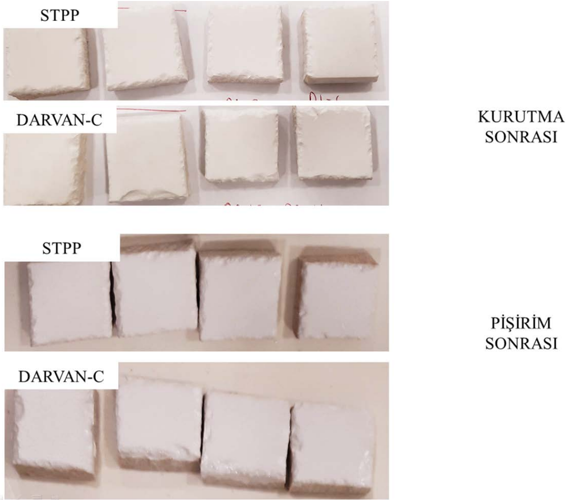
Şekil 4.16. Sır Kompozisyonlarının Yüze Uygulanıp Kurutma İşleminde ve Pişirme İşlemlerinden Sonra Yüzey Özellikleri (Çatlama Gözlenmemiştir)
