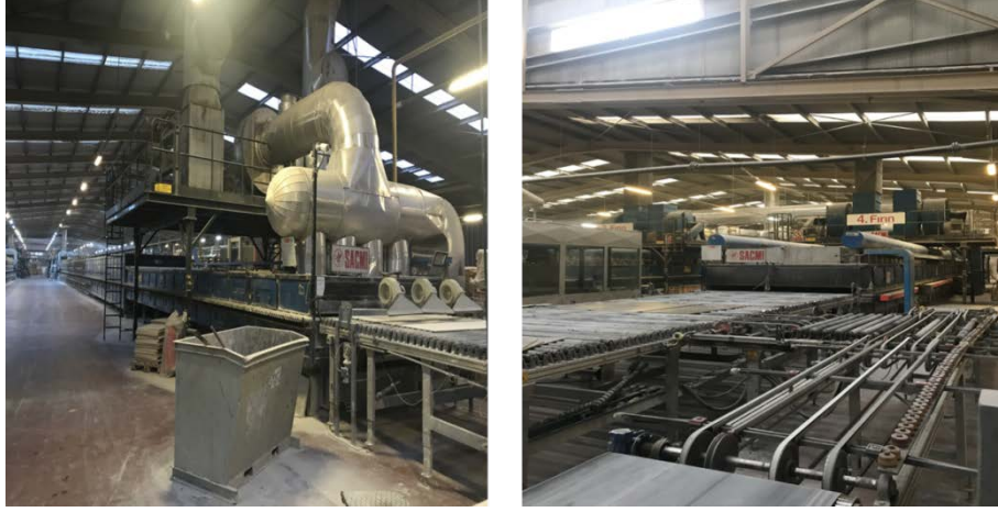
Şekil 3.7. Pişirmelerin Gerçekleştiği Seranit Firmasına Ait Sacmi Markalı Fırın
