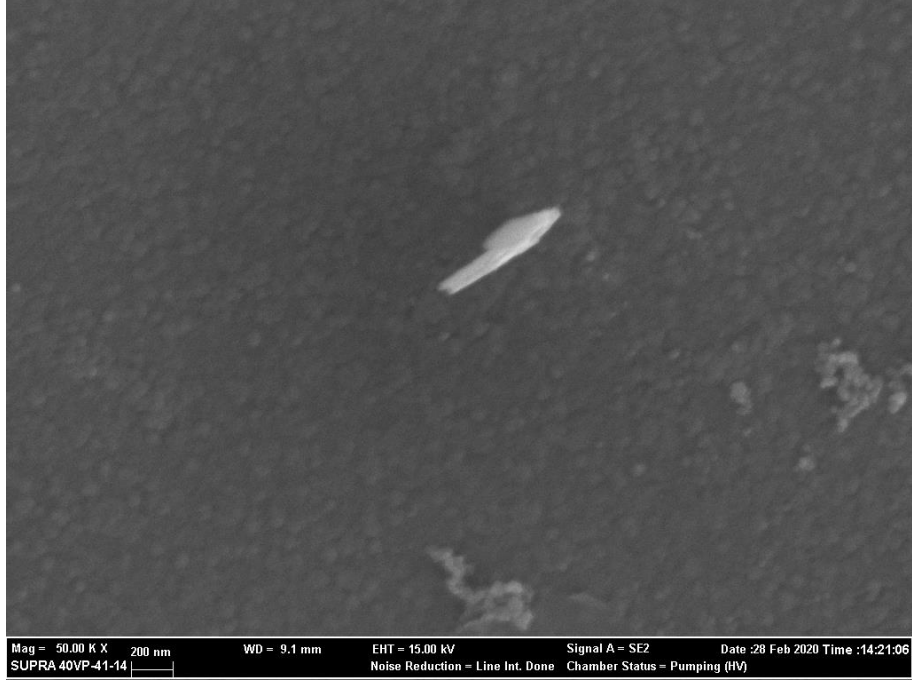
Şekil 14. D1'den elde edilen filmlerin 50000 büyütmedeki SEM görüntüsü
