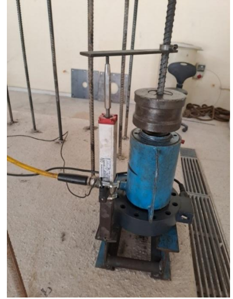
Şekil 4.4. Nervürlü Donatılar İçin Deneş Düzeneginin Şematik Gösterimi ve Görseli
