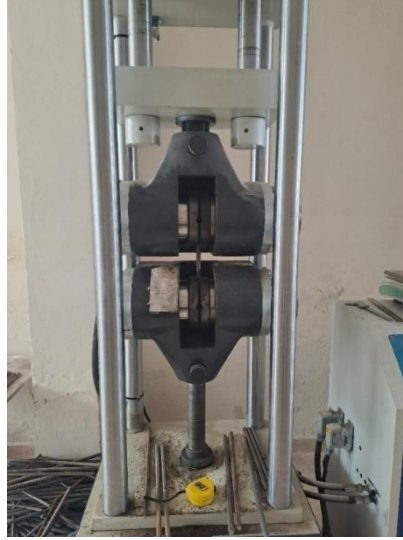
Şekil 4.1. Çekme Testi Uygulaması
