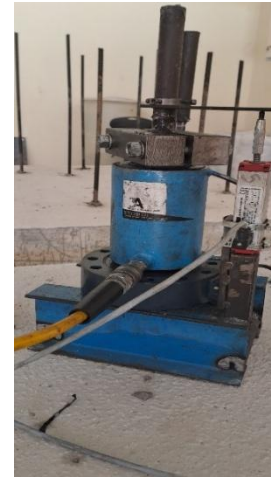
Şekil 4.5. GFRP Donatılar İçin Deneş Düzeneginin Şematik Gösterimi ve Görseli
