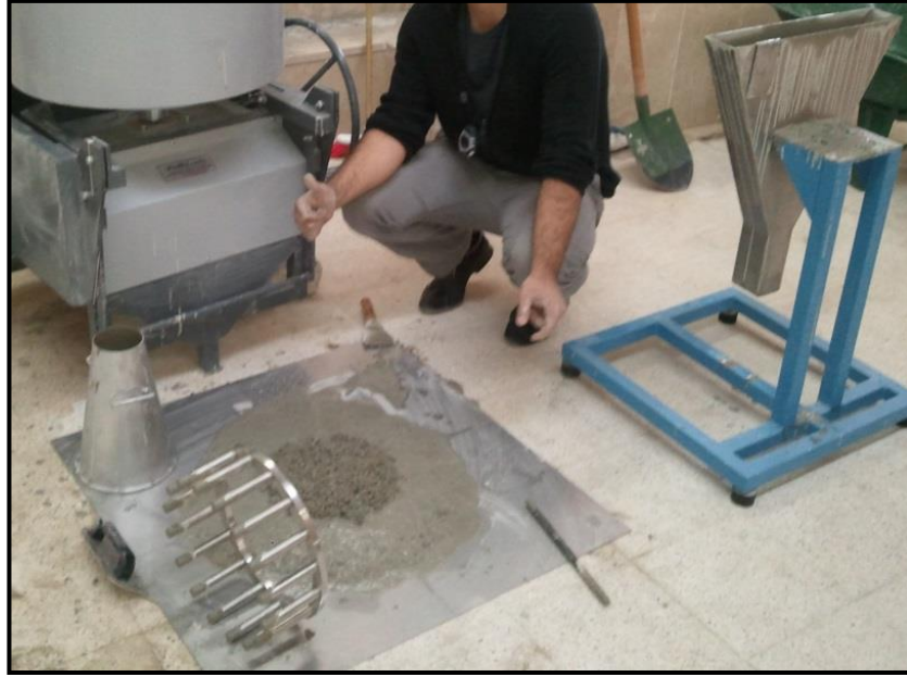
Şekil 3.13. J- halkası deneyinin yapılışı.
