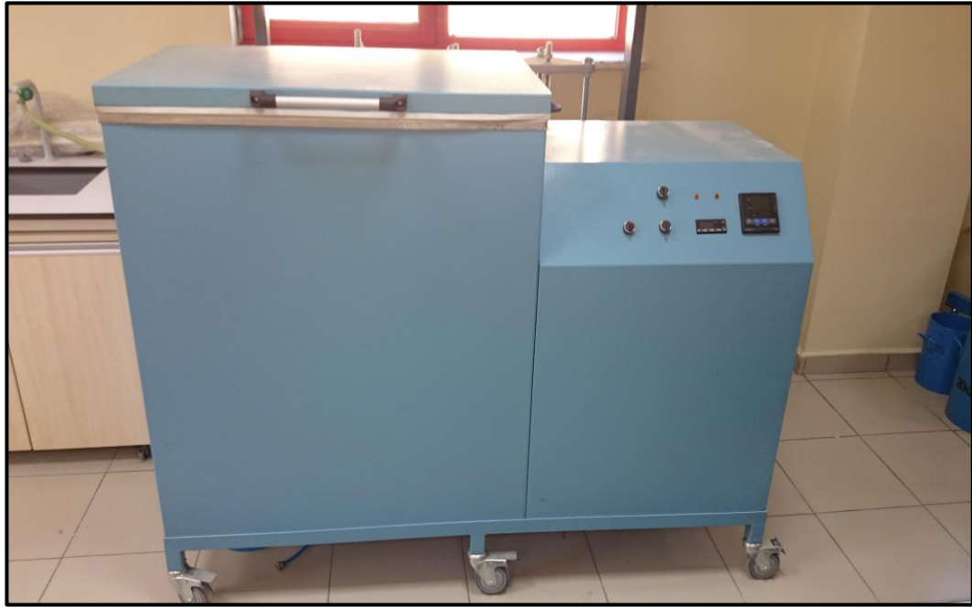
Şekil 3.20. Donma çözülme direnci deney cihazı.
