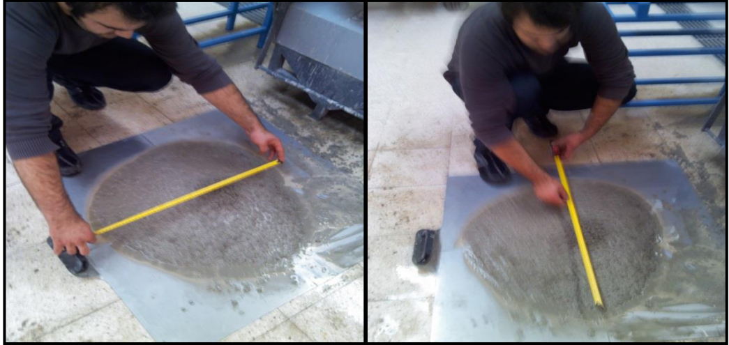
Şekil 3.15. T_{50} ve yayılma deneyinin yapılışı.
