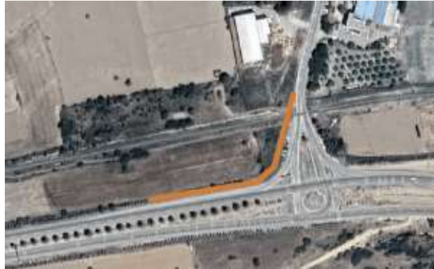
Şekil 5. Yola paralel 3m yükseklikte yansıma kesici opak bariyer
