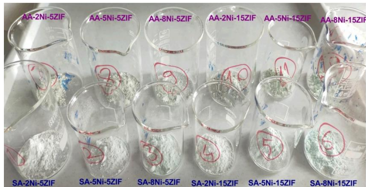
Şekil 5.7. Katalitik Aktivite Belirleme Çalışmalarında Kullanılan AA-xNi-yZIF ve SA-xNi-yZIF Kodlu Katalizörlerin görselleri (x: 2, 5, 8 ve y: 5, 15)
