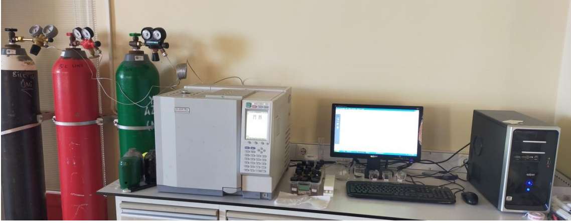
Şekil 5.3. Katalitik Aktivite Belirleme Çalışmalarında Kullanılan Gaz Kromatografi Cihazı
