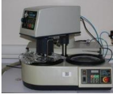
Şekil 4.12. Zımparalama ve parlatma cihazı Metkon Forcipol 2V
