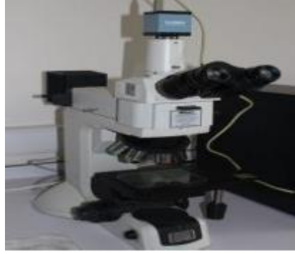
Şekil 4.13. Endüstriyel mikroskop NİKON ECLİPSE LV150N
