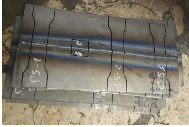
Şekil 4.11. Lazer numune kesim işlemi
