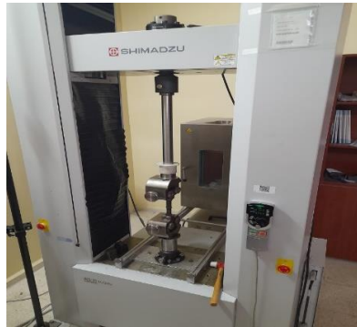
Şekil 4.14. SHIMADZU AG-IC çekme cihazı
