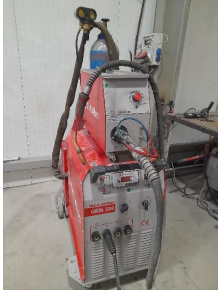
Şekil 4.5. MAG kaynağının yapıldığı GeKaMac GKM500-2W su soğutmalı kaynak makinesi
