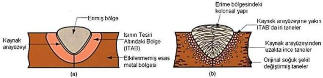
Şekil 5.3. EM, ITAB ve KM bölgelerinde tane görüntüsü şematik gösterimi
