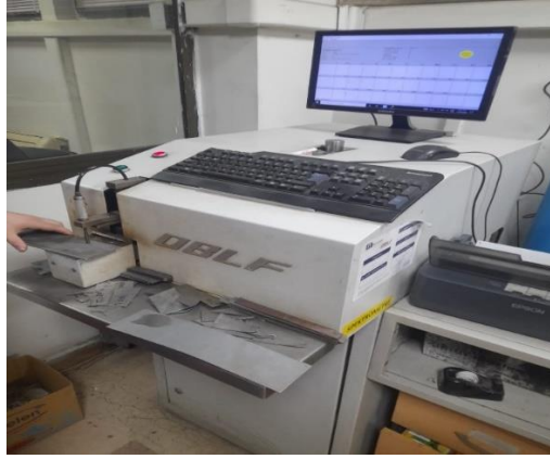
Şekil 4.1. SPH270-C/SPH440-OD çeliklerine ait OBLF marka GS1000 model spektrometre cihazında spektral analiz çalışmaları
