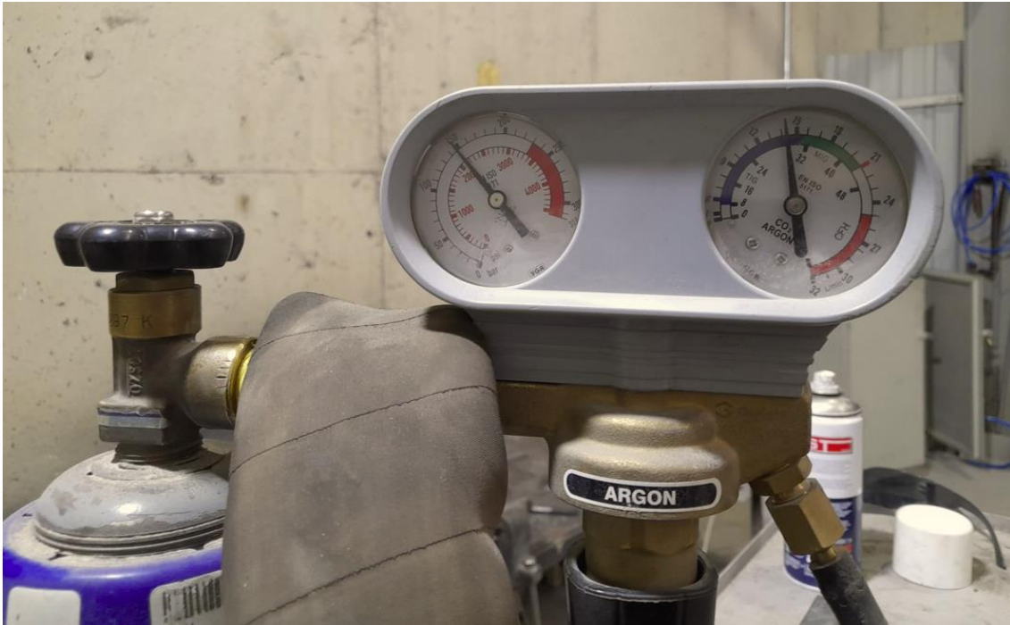
Şekil 3.7. Gazaltı ark kaynağı koruyucu gaz tüpü ve manometre
