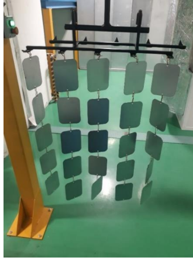
Şekil 4.4. Kurutma işlemi tamamlanan plakaların toz boya işlem öncesi askılanmasına ait fotoğraf.
