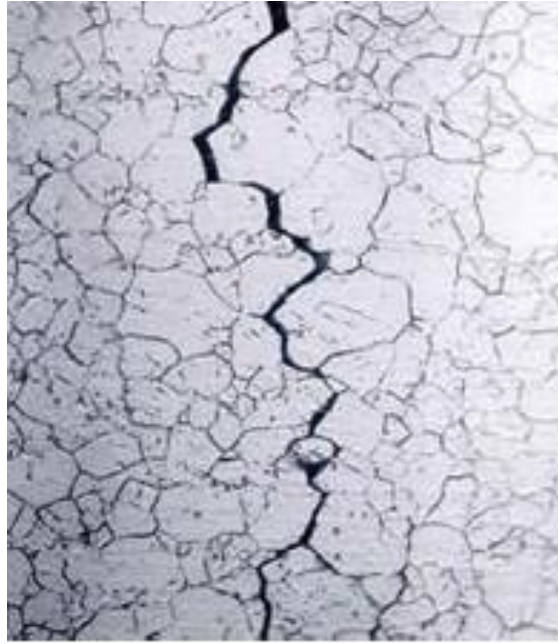
Şekil 2.8. Gerilmeli korozyon ve çatlak oluşumu (URL-4, 2019).
