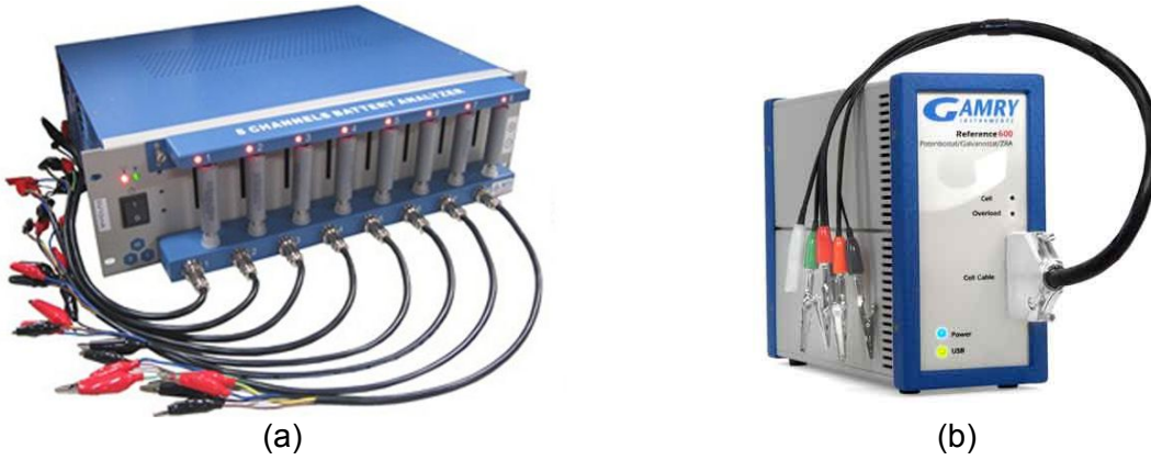
Şekil 3.9. Pillerin karakterizasyonunda kullanılan cihazlar (a) Şarj-deşarj test cihazı (b) CV ve İmpedans test cihazı
