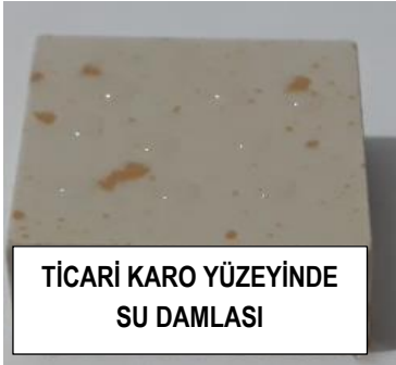
Şekil 4. Temas açıları (a) Ticari porselen karo yüzeyi (35°), (b) Mikro-boyutta ZnO tozu katkılı karo yüzeyi (122°), (c) Nano-boyutta ZnO tozu (N1) katkılı karo yüzeyi (135°), (d) Nano-boyutta ZnO tozu (N2) katkılı karo yüzeyi (132°)
