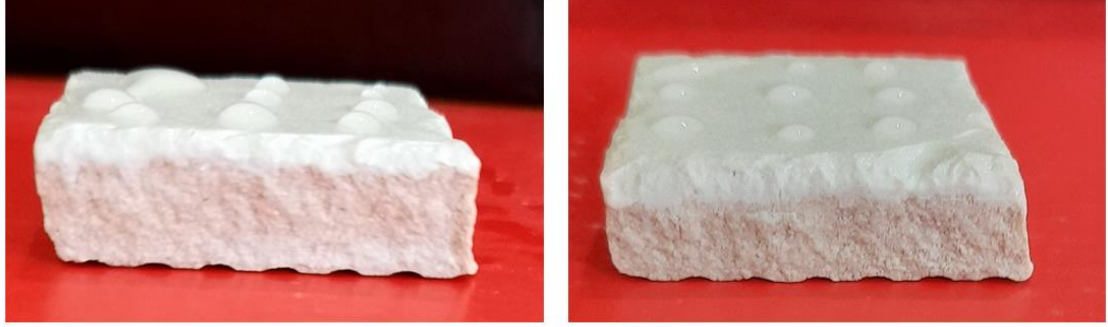
Şekil 4.20. (a) S ve (b) D kodlu yüzeylerde su damlasının davranışı
