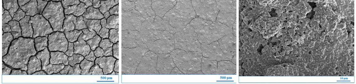
Şekil 4.17. (a) Hacimce %5 ve (b,c) %2.5 nano ZnO katkılı yüzeylerin SEM-SE görüntüsü (c) topaklanmış nano ZnO taneleri
