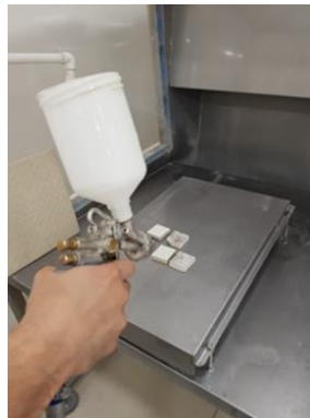
Şekil 3.5. Spreyleme tekniği ile sır uygulama işleminin gösterimi
