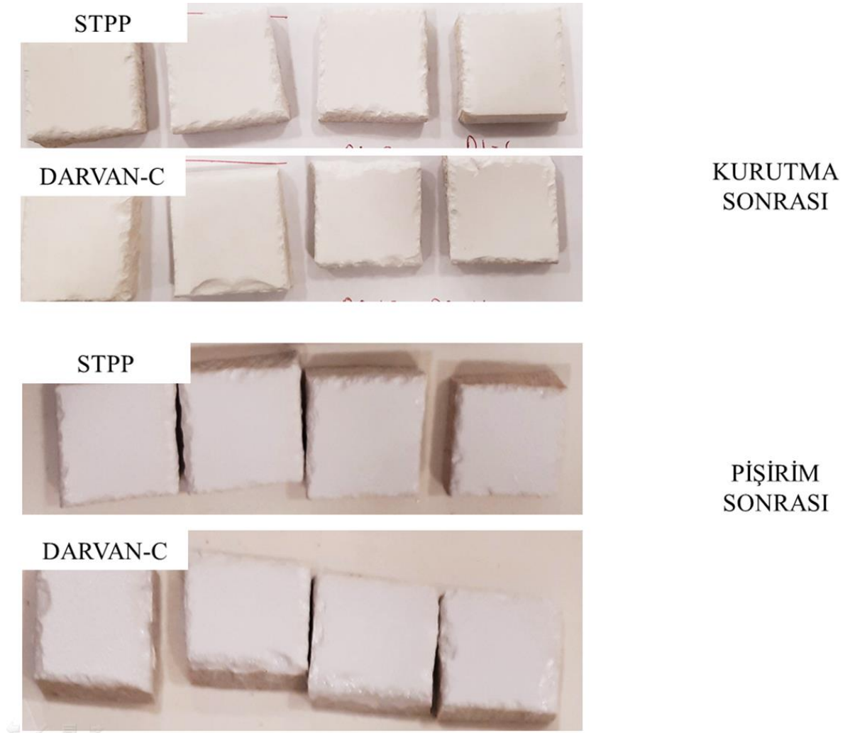
Şekil 4.19. Sır kompozisyonlarının yüzeye uygulanıp kurutma işleminden ve pişirme işlemlerinden sonra yüzey özellikleri (çatlama gözlenmemiştir)
