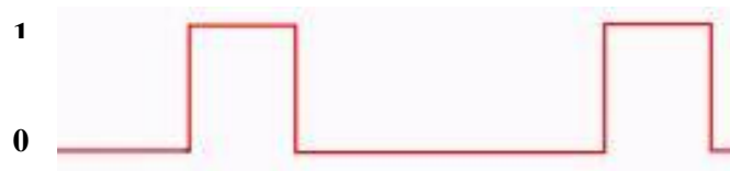
Şekil 2.8. Su sensörüne su temasının olduğu ve olmadığı durumlara ait grafik.
