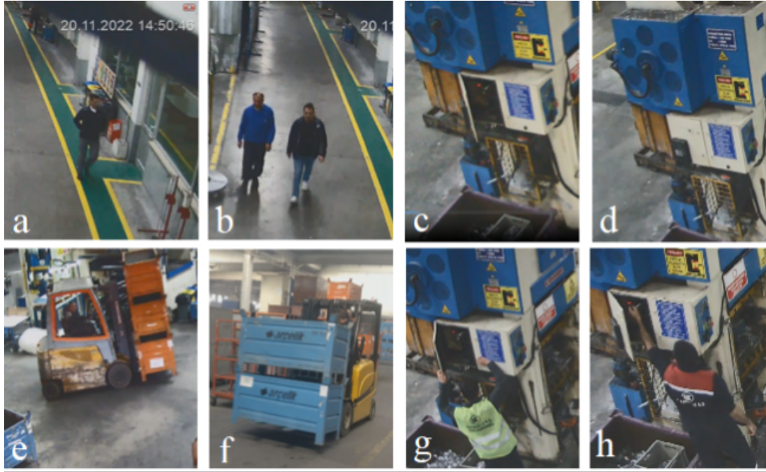
Şekil 3.3. Verisetinde güvenli ve güvensiz sınıflarına ait davranışlara örnekler. (a) Güvenli Yürüyüş Yolu, (b) Güvenli Yürüyüş Yolu İhlali, (c) Açık Pano Kapağı, (d) Kapalı Pano Kapağı, (e) Forklift ile Aşırı Yük Taşıma, (f) Güvenli Yük Taşıma, (g) Yetkili Müdahale, (h) Yetkisiz Müdahale
