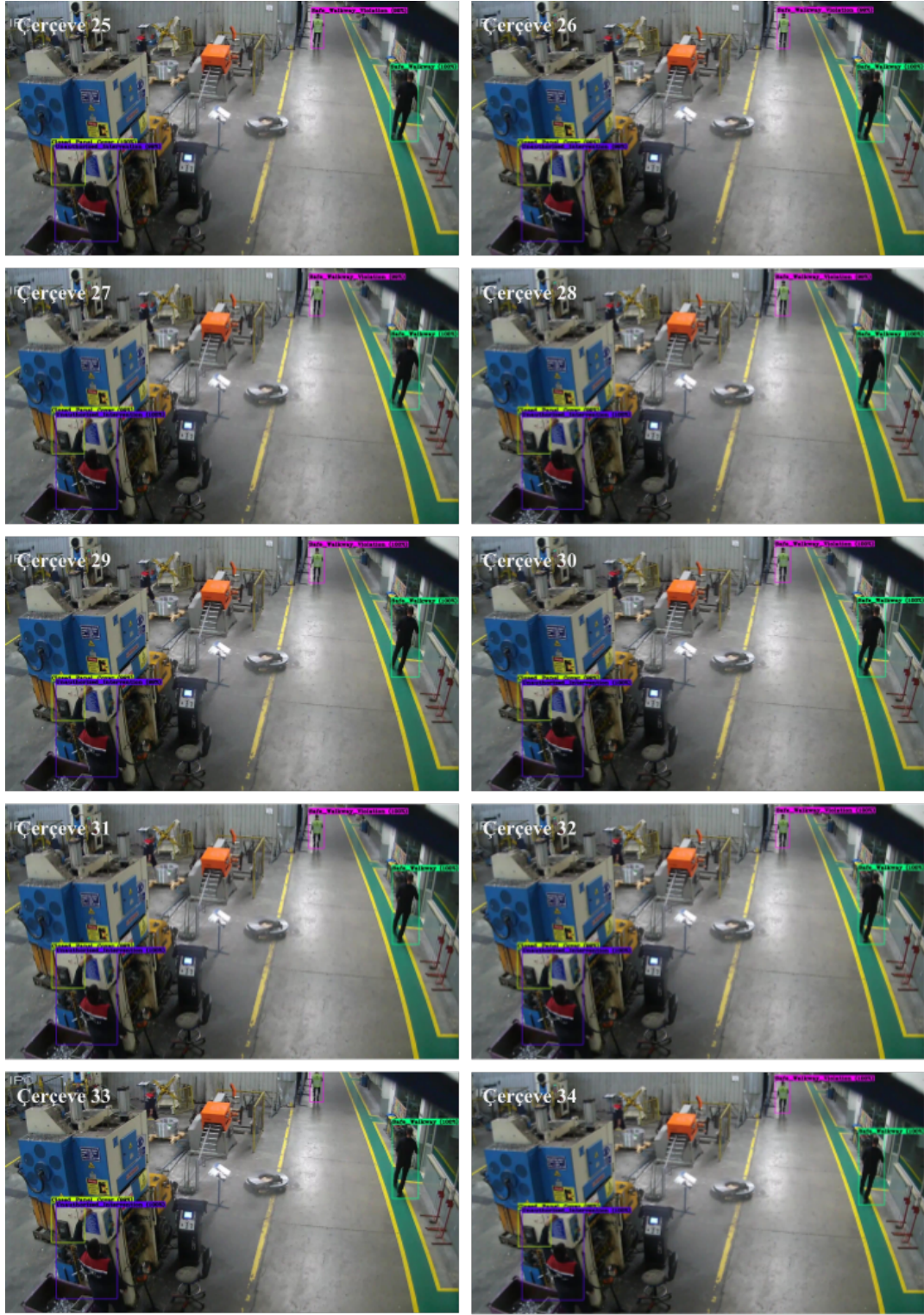
Şekil 4.4. Başlangıçta 105 çerçeveden oluşan bir video parçasının YOLOv4 ağından geçirildikten sonra, içerisinde 3 eylem ve 40 çerçeveden oluşan bir hale gelmesi ve azaltılmış videodaki bazı örnek çerçeveler
