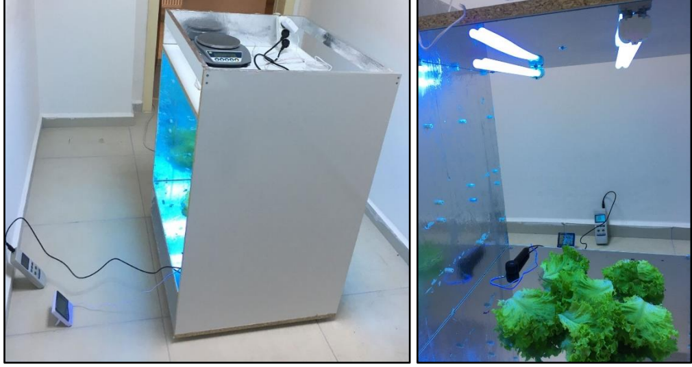
Şekil 3.5. Tez Kapsamında Oluşturulan Kabin ve Marul Örneklerine UV Uygulaması
