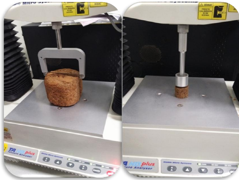
Şekil 4.5. Tekstür analizi kesme ve sıkıştırma testi görselleri.
