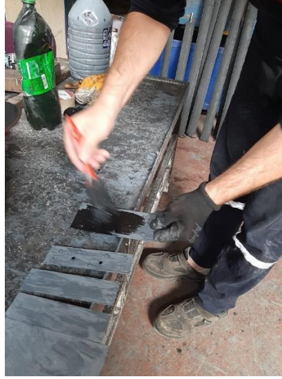
Şekil 4.6. Fırça ile Bağlayıcı Uygulanması
