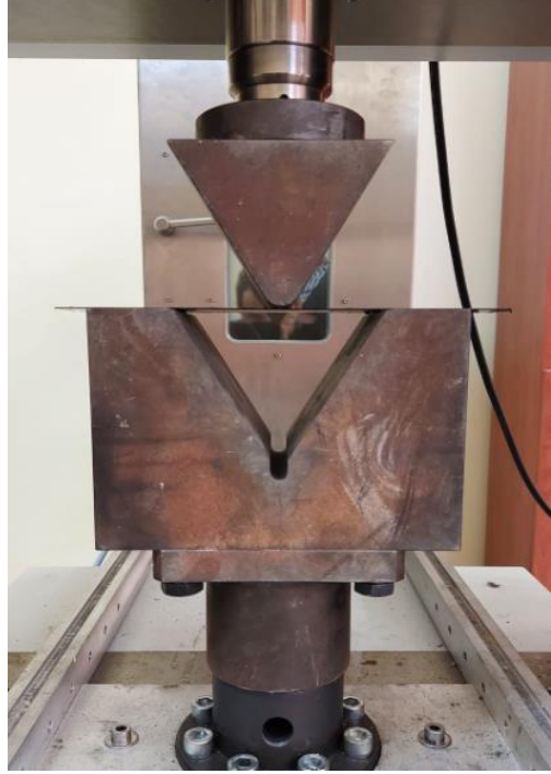
Şekil 5.1. V-Kalıpta Eğme Deney Düzenegi
