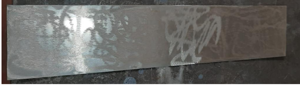
Şekil 4.4. Yapışma Yüzeyi Taşlanmış Sac Metal
