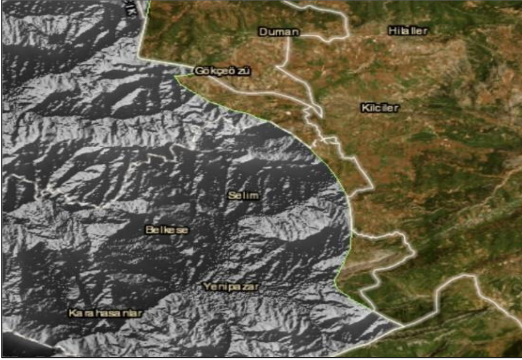
Harita 3.2. Create Random Points ve Raster Calculator işlemleri sonrası havza sınırlarında görülen geometrik hatalar.
