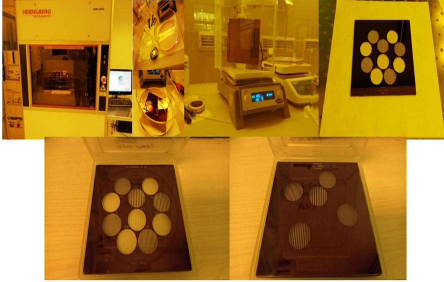
Şekil 6.3. Heidelberg DWL 66fs Krom Maske Basım Cihazı, Heidelberg 'te basım sonrası Krom Maske'nin Cr Etcher içinde bekletilmesi, AZ100 Remover içinde +80° C maskenin fotorezistten temizlenmesi, Heidelberg DWL 66fs ile basılmış Krom Maske Çalışması
