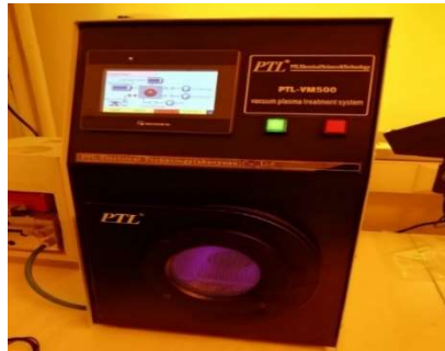
Şekil 6.6. Oksijen plazma Cihazı(PTL-VM500 Vacuum Plasma Treatment System)
