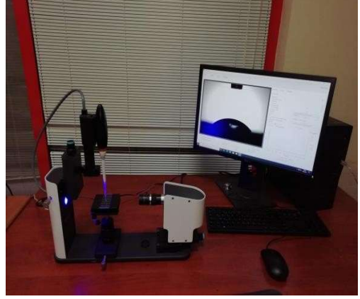
Şekil 6.10. (a) Signatone 4-prop İletkenlik Cihazı ve (b) Biolin Scientific Attention Theta Lite Temas Açısı Cihazı dijital fotoğrafları
