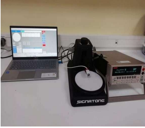
Şekil 6.10. (a) Signatone 4-prop İletkenlik Cihazı ve (b) Biolin Scientific Attention Theta Lite Temas Açısı Cihazı dijital fotoğrafları
