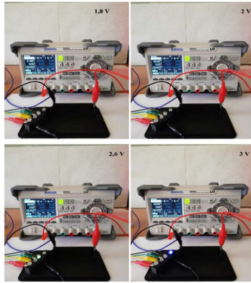
Şekil 7.22. r-(PS+GO@THF-DC-4) yüzeyi için led diyot yakma performans uygulaması sırasında alınan dijital fotoğraflar
