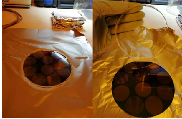
Şekil 6.7. PDMS'in Si-Wafer üzerinden ayrılması
