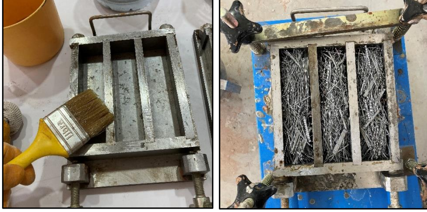
Şekil 3.5. Ön döküm için prizmatik kalıpların hazırlanması
