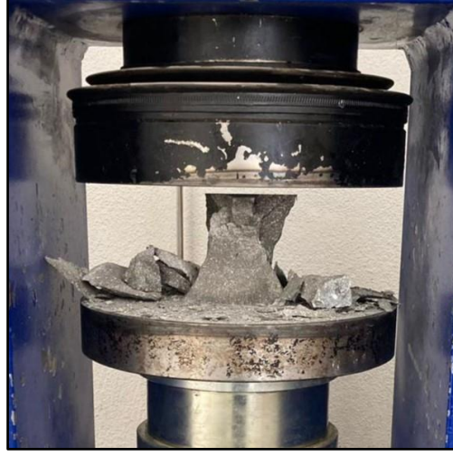
Şekil 3.15. Basınç dayanımı deneyi uygulaması
