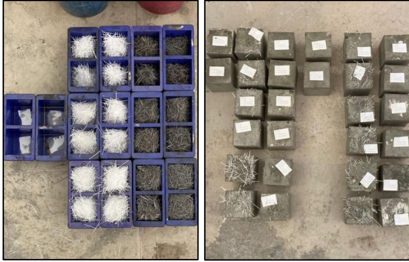
Şekil 3.9. Hazırlanan karışımın kalıplara yerleştirilmesi ve kalıptan çıkarılan numunelerin kodlanması
