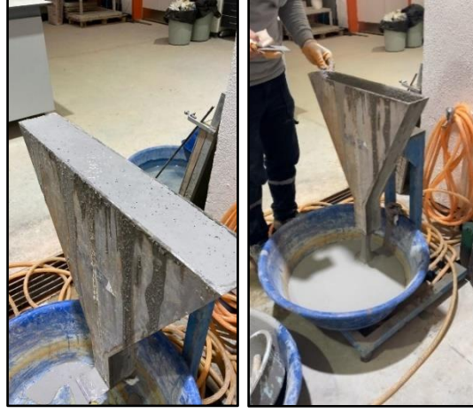
Şekil 3.11. V hunisi deneyi uygulaması
