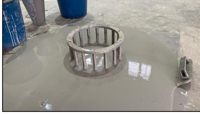
Şekil 3.13. J halkası deneyi uygulaması
