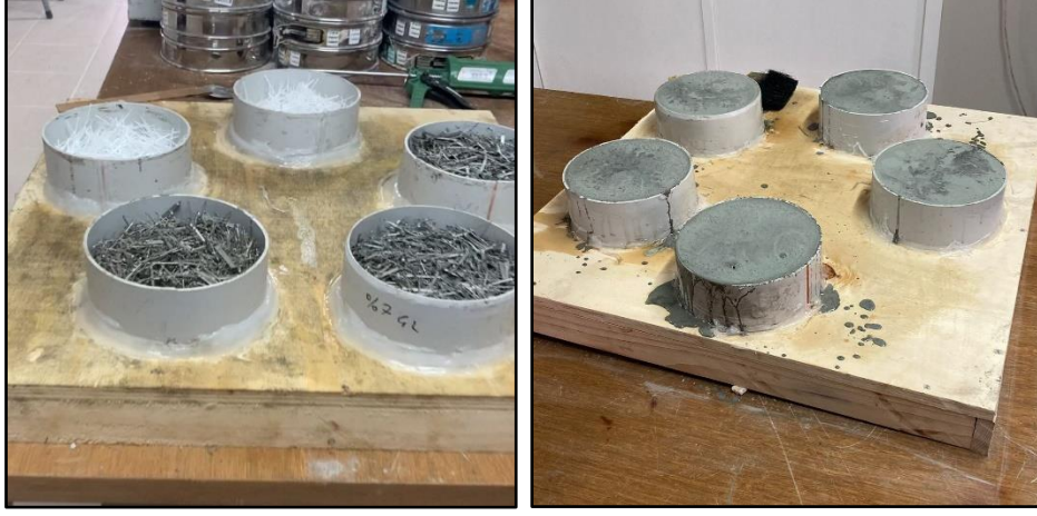
Şekil 3.18. Disk numune üretimi
