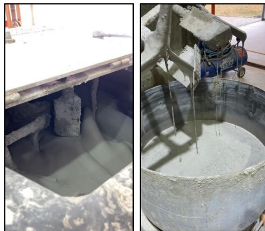
Şekil 3.8. Karışımın mikserde hazırlanması
