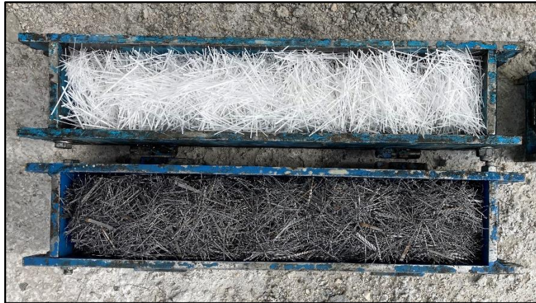
Şekil 3.16. Kiriş numune üretimi
