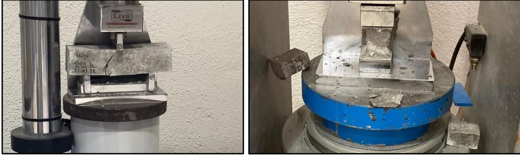
Şekil 3.7. Prizmatik numunelerde uygulanan eğilme ve basınç dayanımı deneyleri
