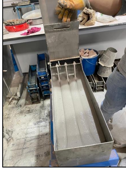
Şekil 3.12. L kutusu deneyi uygulaması
