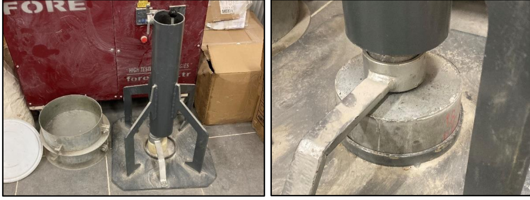
Şekil 3.19. Ağırlık düşürme deney düzeneği ve numune üzerinde uygulaması
