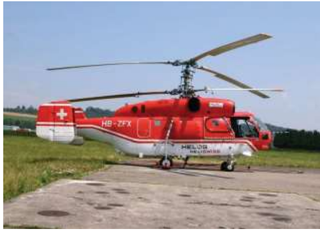
Şekil 6.3. Eş eksenli rotorlu helikopter (FAA-H-8083-21A, 2012).
