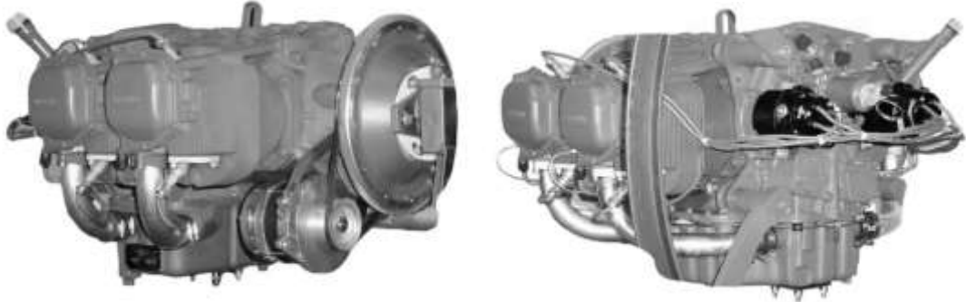
Şekil 8.4. O 320 motorun sağ ve sol görüntüsü (O 320).
