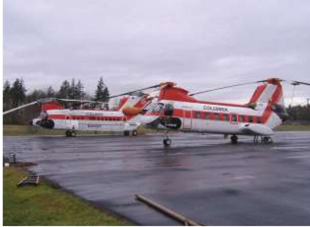
Şekil 6.4. Ardışık rotorlu helikopter (FAA-H-8083-21A, 2012).
