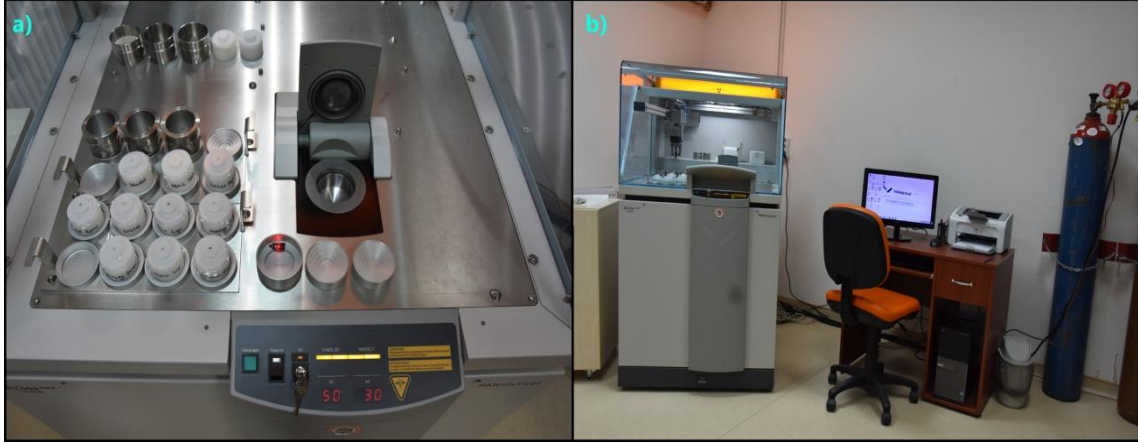
Şekil 42: XRF Analizi İçin Laboratuardaki Akış Şeması.
