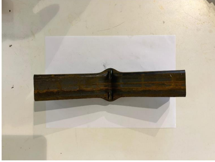
Şekil 4.7. Kare kesitli profilin R5 zımba yarıçapında deforme olmuş hali – üst görünüm.
