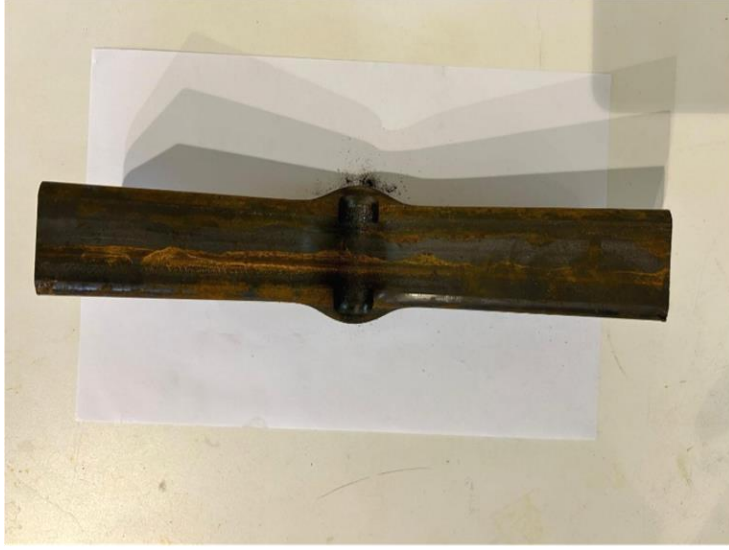
Şekil 4.9. Kare kesitli profilin R10 zımba yarıçapında deforme olmuş hali – üst görünüm.
