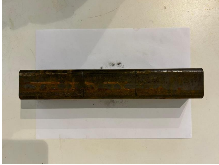
Şekil 4.13. Kare kesitli profilin 4 nokta eğme deneyinde deforme olamamış hali – üst görünüm.
