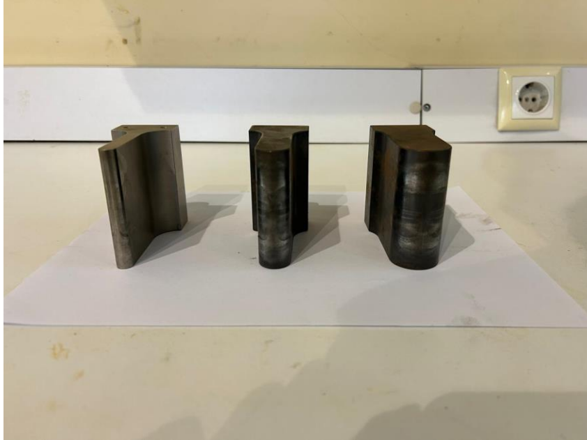
Şekil 4.6. Deneylerde kullanılan farklı radüslere sahip (R5, R10, R15) zımba geometrileri.
