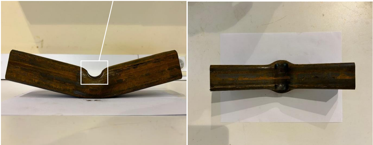
Şekil 4.29. Kare kesit profilin üç nokta eğme testinde S200 mesnet aralığı ve R15 zımba yarıçapı ile birlikte deneysel ve sonlu elemanlar analizi karşılaştırılması.
