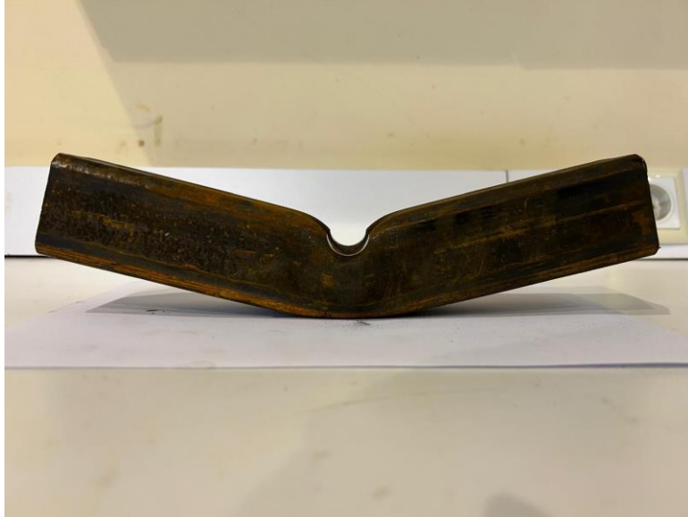
Şekil 4.10. Kare kesitli profilin R10 zımba yarıçapında deforme olmuş hali – yan görünüm.
