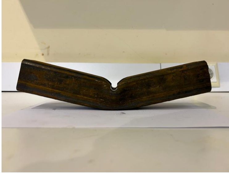
Şekil 4.8. Kare kesitli profilin R5 zımba yarıçapında deforme olmuş hali – yan görünüm.
