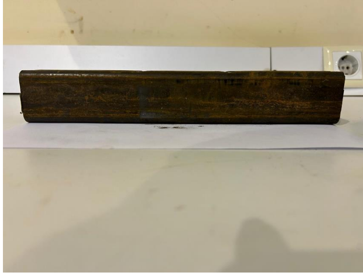
Şekil 4.14. Kare kesitli profilin 4 nokta eğme deneyinde deforme olamamış hali – ön görünüm.
