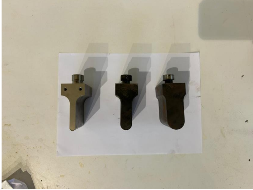
Şekil 4.5. Deneylerde kullanılan farklı radüslere sahip (R5, R10, R15) zımba geometrileri.
