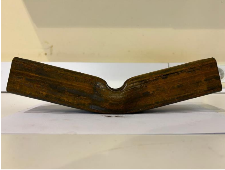
Şekil 4.12. Kare kesitli profilin R15 zımba yarıçapında deforme olmuş hali – yan görünüm.
