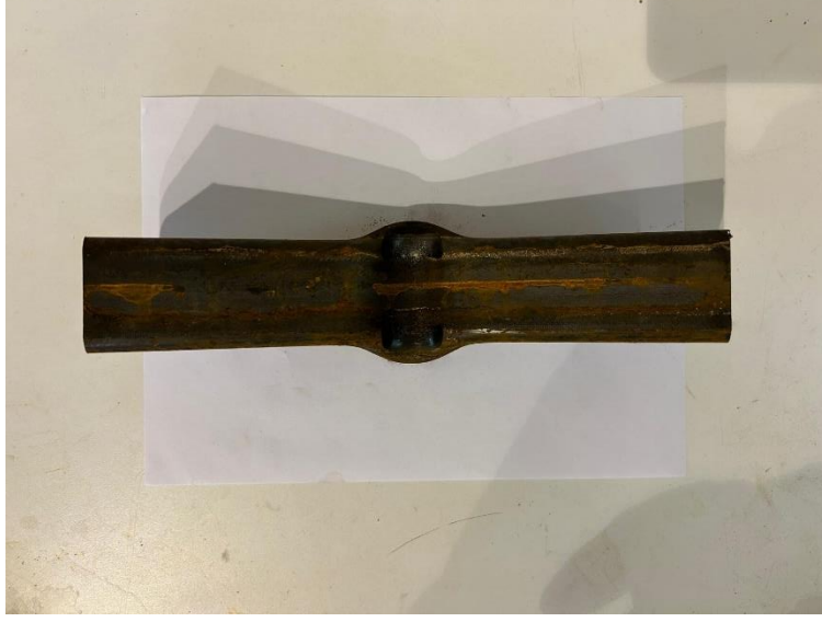
Şekil 4.11. Kare kesitli profilin R15 zımba yarıçapında deforme olmuş hali – üst görünüm.
