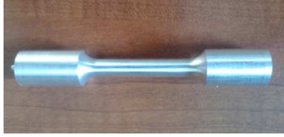
Şekil 6.6. Çekme çubuğu örneği.
