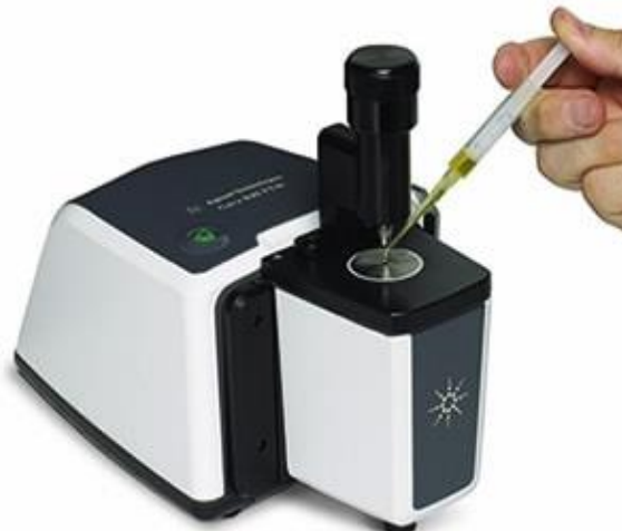
Şekil 5.3.FT-IR (Cary 630) cihazı (URL-3, 2020)
