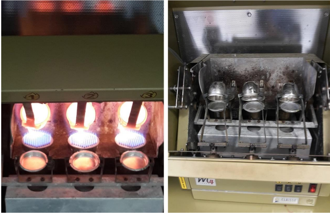
Resim 118: Eriyen Örneklerin Kroze Altlıklarına Boşaltılması ve Soğuma İşlemi
