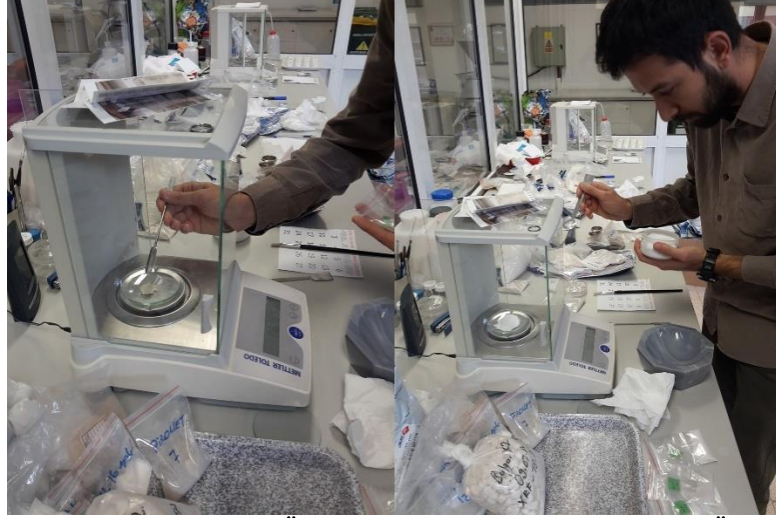
Resim 112: Toz Halindeki Örneklerin Hassas Tartı Yardımı ile Ölçülmesi
