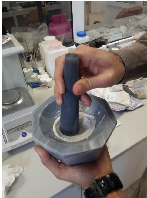
Resim 113: Havan İçerisinde Örneğin Homojen Hale Getirilmesi
