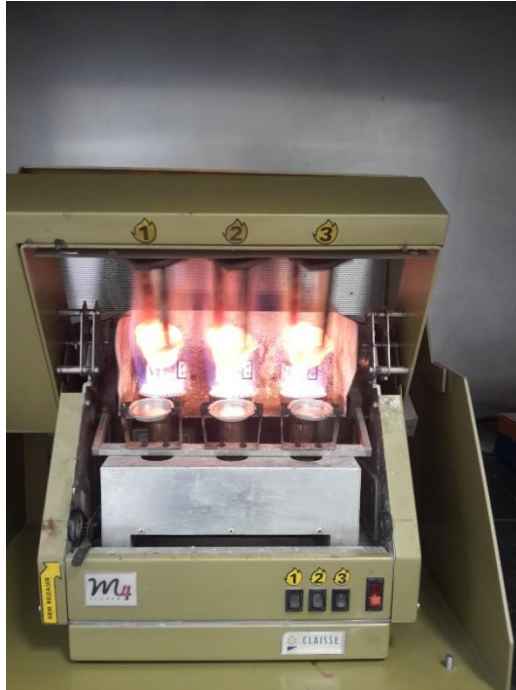
Resim 117: Örneklerin Karıştırılarak Eritilmesi
