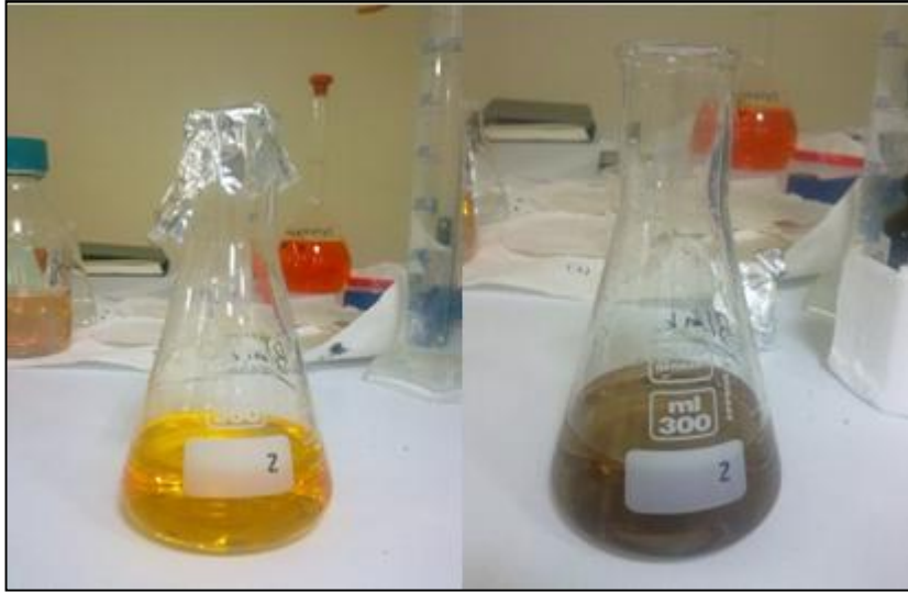
Şekil 8.6. KOİ deneyinde renk değişimi safhaları.
