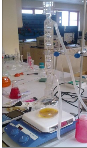
Şekil 8.4. KOİ analizinde kullanılan deney düzeneği.
