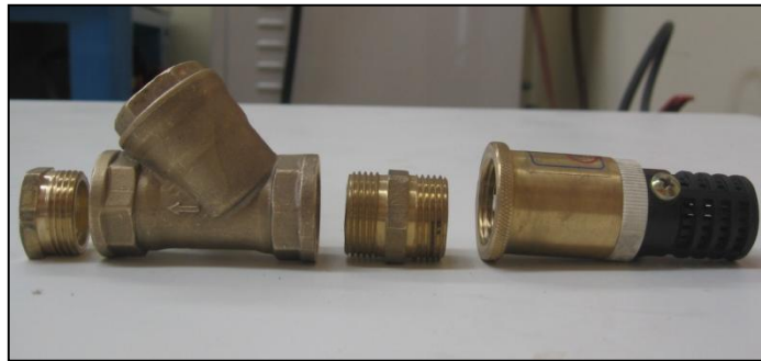
Şekil 7.34. Ön filtre parçalarının demonte görüntüsü.
