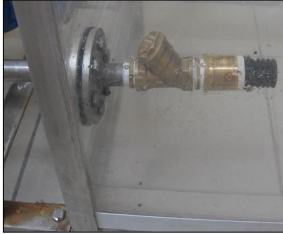
Şekil 7.35. Ön filtre parçalarının montaj sonrası görüntüsü.
