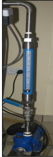
Şekil 7.19 Debimetrenin montaj sonrası görüntüsü.
