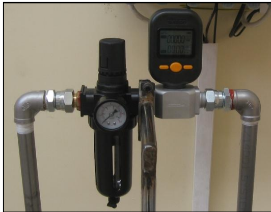
Şekil 7.16. Hava şartlandırıcı MBR üzerindeki montajlı görünümü.
