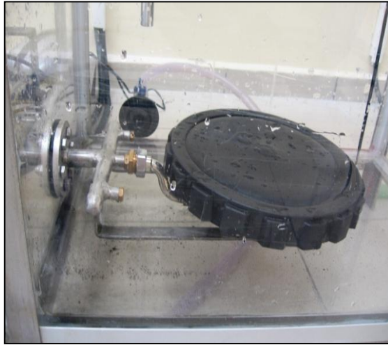
Şekil 7.11. Difüzörün montaj sonrası görüntüsü.
