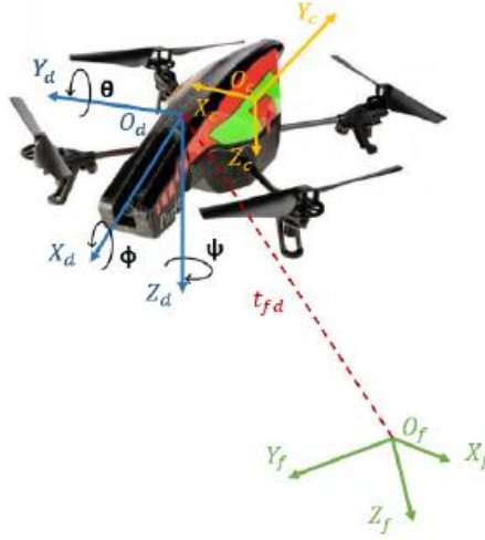
Şekil 2.5. Parrot Drone için kamera düzlemi, drone düzlemi ve sabit düzlem gösterimi (Pereira, 2021)
