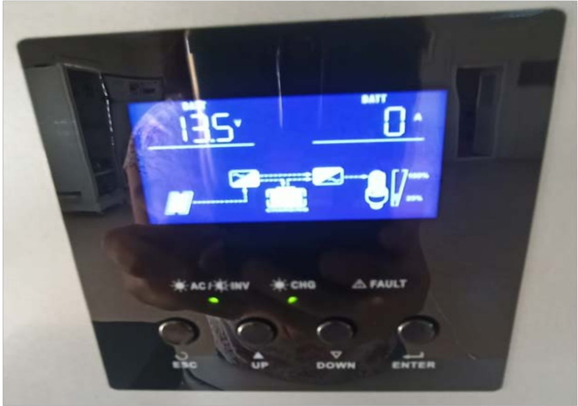
Şekil 4.30. Yük devrede değilken a) batarya gerilimi ve yük güç değeri b) batarya gerilimi ve akımı değerleri
