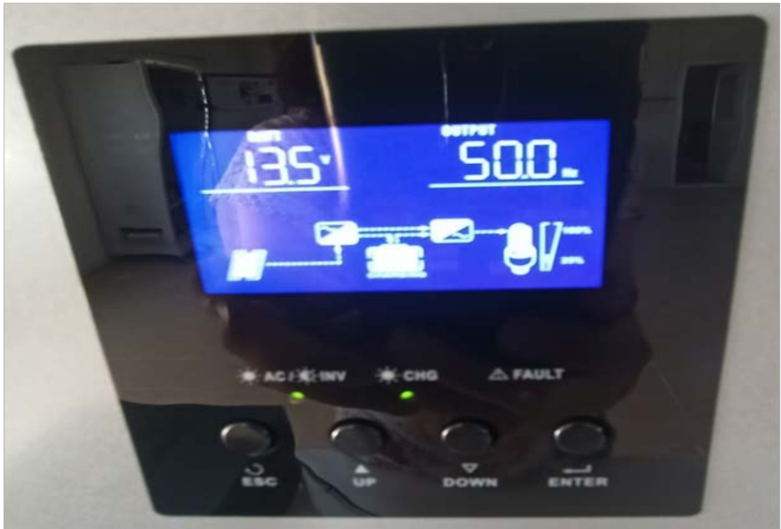
Şekil 4.30. Yük devrede değilken a) batarya gerilimi ve yük güç değeri b) batarya gerilimi ve akımı değerleri
