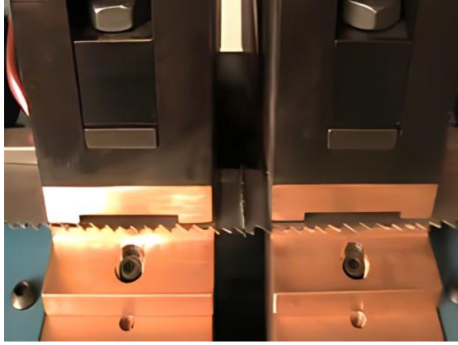
Şekil 3.6. Testere lamalarının kaynak ile birleştirilme işlemi
