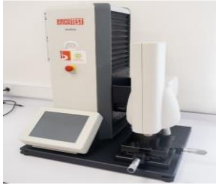
Şekil 4.12. EMCOTEST DUROSCAN 20 mikro sertlik ölçüm cihazı
