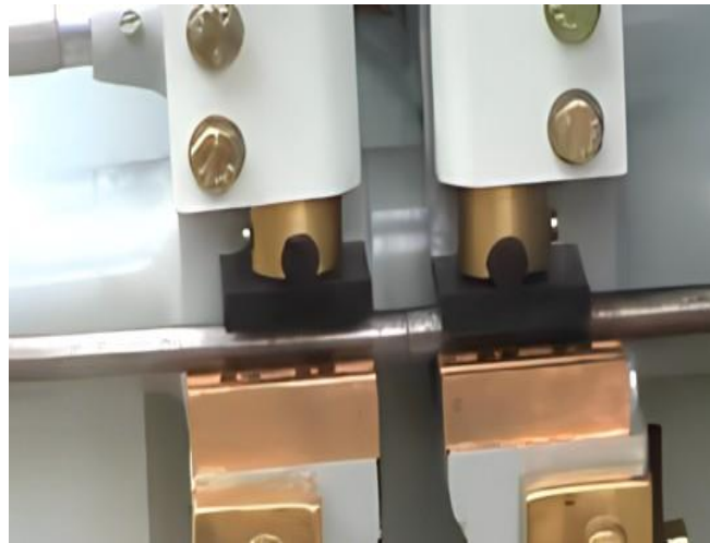
Şekil 3.3. Ön ısıtmasız yakma alın kaynağında malzemelerin bağlanması
