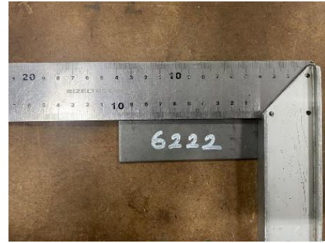
Şekil 4.3. DC04-HRP6222 Sacların 100 mm kesilmesi
