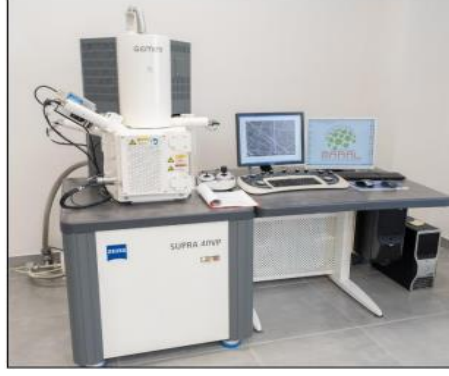
Şekil 4.14. ZEISS / Supra 40 VP taramalı elektron mikroskobu (SEM)
