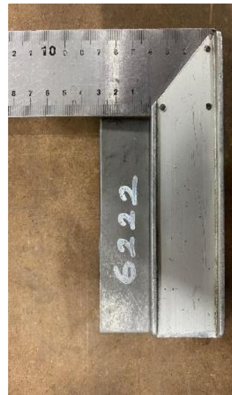
Şekil 4.4. DC04-HRP6222 Sacların 30 mm kesilmesi
