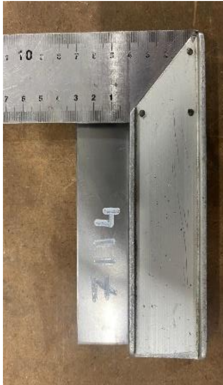
Şekil 4.4. DC04-HRP6222 Sacların 30 mm kesilmesi
