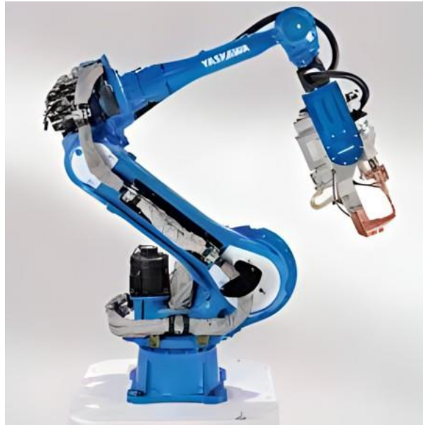
Şekil 3.13. Robot kollu nokta direnç kaynak makinesi
