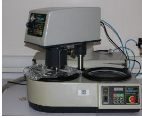
Şekil 4.10. MEKTON FORCİPOL 2V zımparalama ve parlatma cihazı
