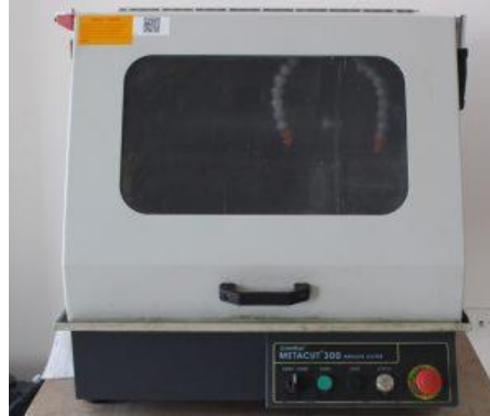
Şekil 4.9. METKON METACUT-300 hassas kesme cihazı
