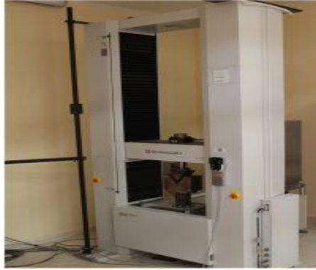
Şekil 4.13. SHİMADZU AG-IC çekme makaslama test cihazı
