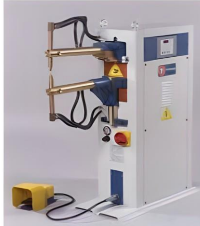
Şekil 3.10. Mekanik nokta direnç kaynak makinesi
