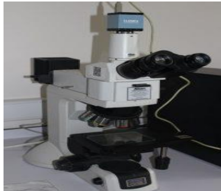
Şekil 4.11. NİKON ECLİPSE LV150N endüstriyel mikroskop
