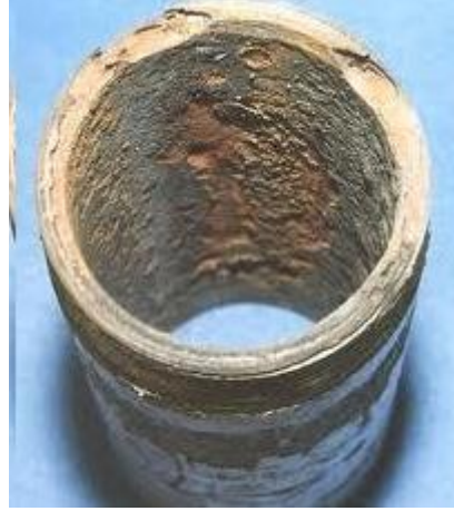
Şekli 2.10. Magnezyum boruda meydana gelen çukurcuk korozyonu (ASM Handbook, 1987).
