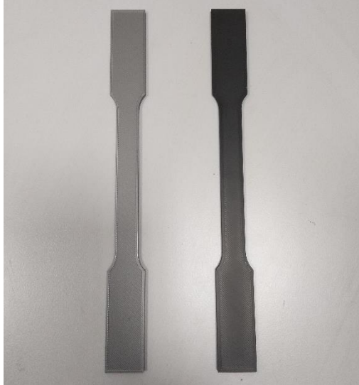
Şekil 4.6. PLA (sol) ve ABS (sağ) malzemeden üretilen çekme test numuneleri
