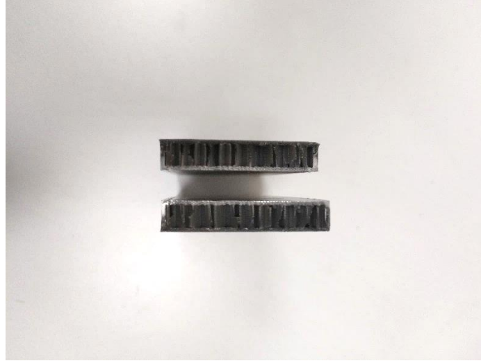
Şekil 4.19. ABS malzemeden üretilen üç nokta eğme numunesinin test sonrası kırılan kesit görüntüsü
