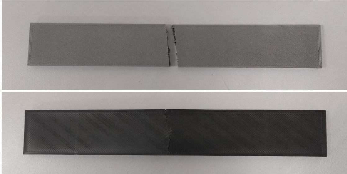
Şekil 4.18. PLA (üst) ve ABS (alt) test numunelerinin üç nokta eğme deneyi sonrası örnek numune görseli
