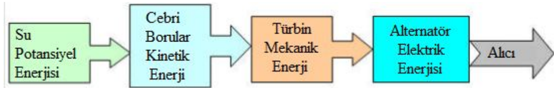
Şekil 2.2. HES enerji dönüşüm şeması.
