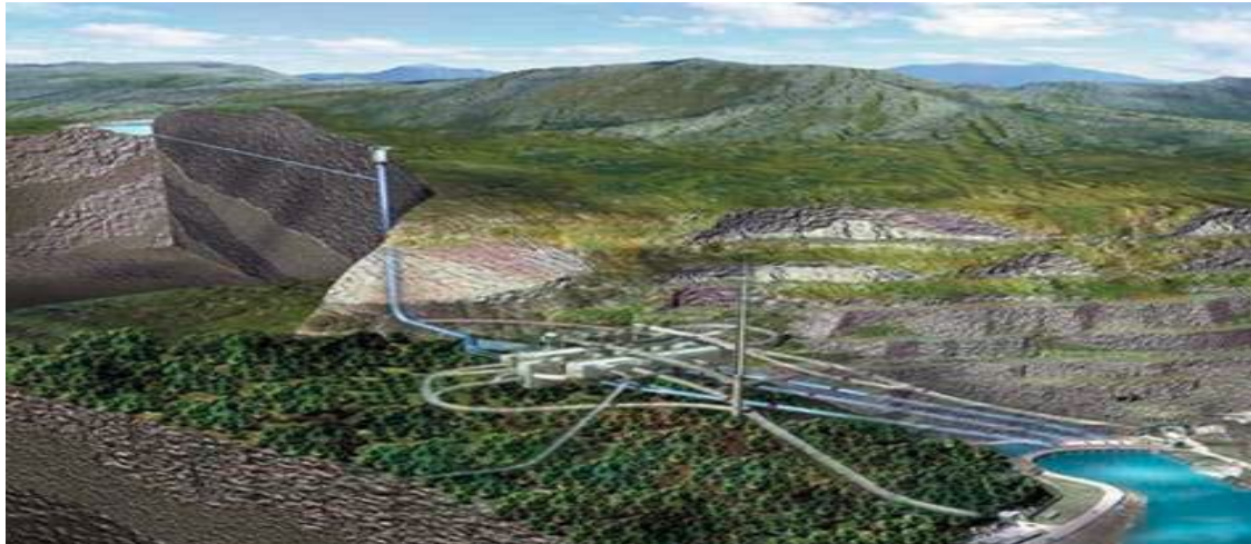
Şekil 4.14 . Dinorwig hazneli pompalı HES'in kesiti.
