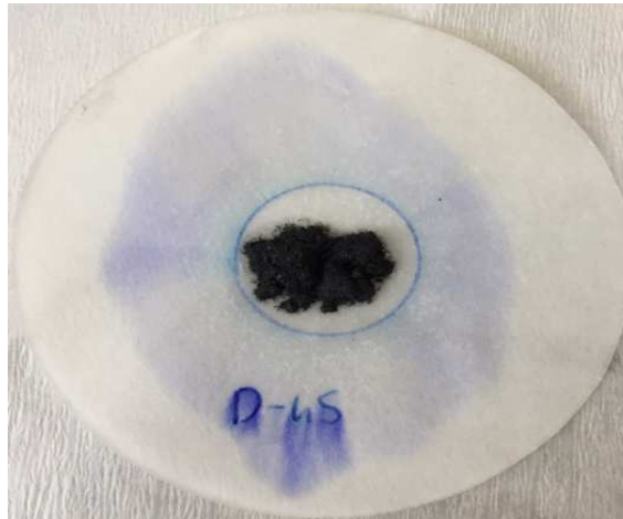
Şekil 4.22. Grafit kullanılarak üretilen OFDM'nin sızdırmazlık testi görünümü
