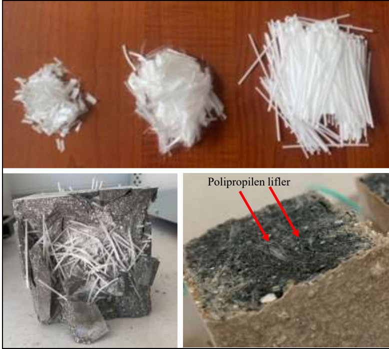
Şekil 1: Polipropilen liflerin harç ve betonlarda kullanımı (Şenol, 2022:11)
