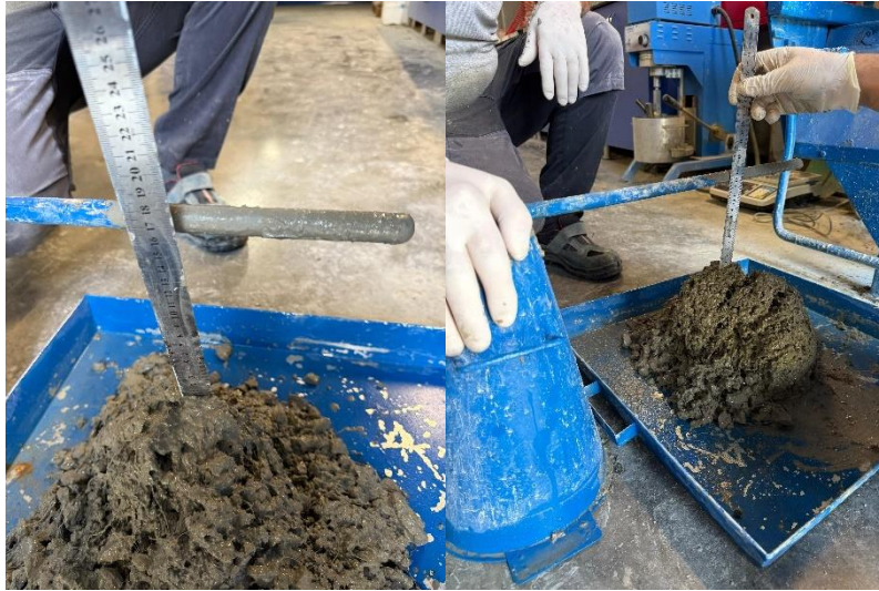
Şekil 6.4. R ve numune betonunun çökme değerlerinin belirlenmesi
