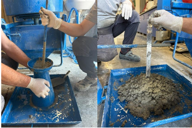
Şekil 6.3. Yalın betonun çökme değerlerinin belirlenmesi
