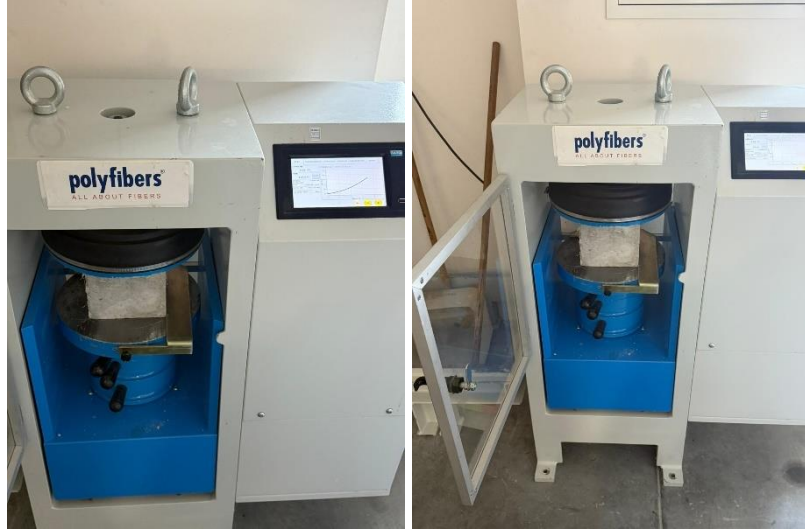
Şekil 6.7. Tek eksenli beton basınç dayanım deneyi
