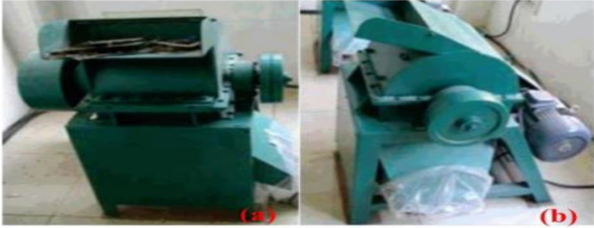
Şekil 3.16. EEEA'lar İçin Kırma Ekipmanları: (A) Kesme Makinesi; (B) Çekip Değirmeni
