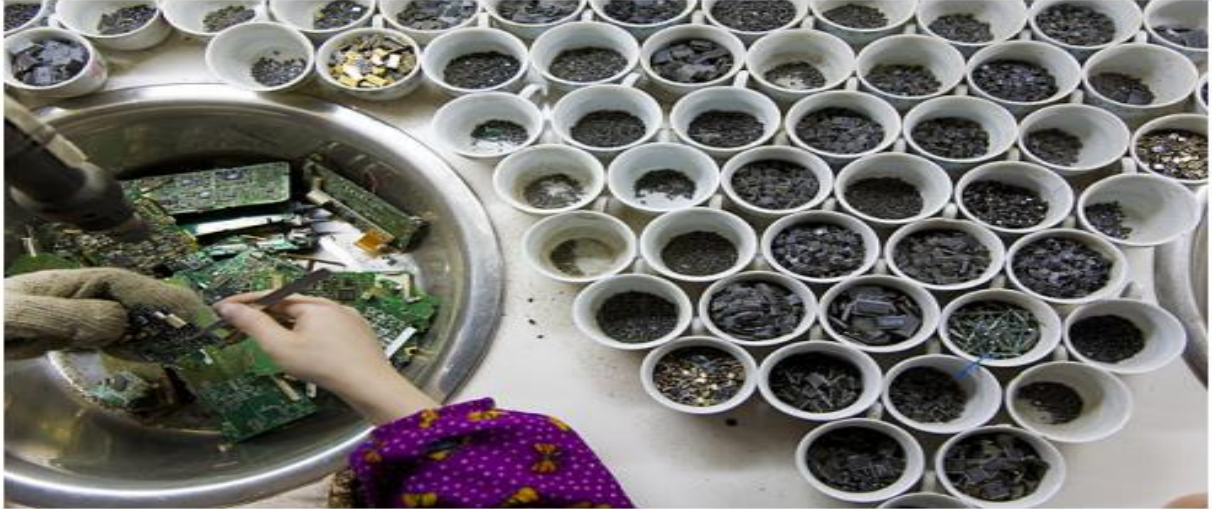
Şekil 3.10. Elektronik Atıklardan Ayrıştırılan Plastik, Metaller Ve Çipler
