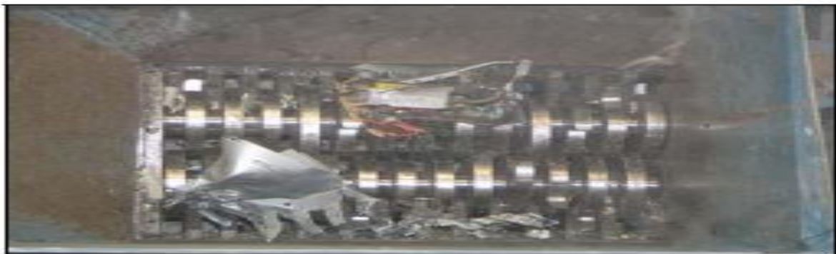
Şekil 3.13. Kesicide Boyut Küçültme İşlemi (Güç Kutusu)
